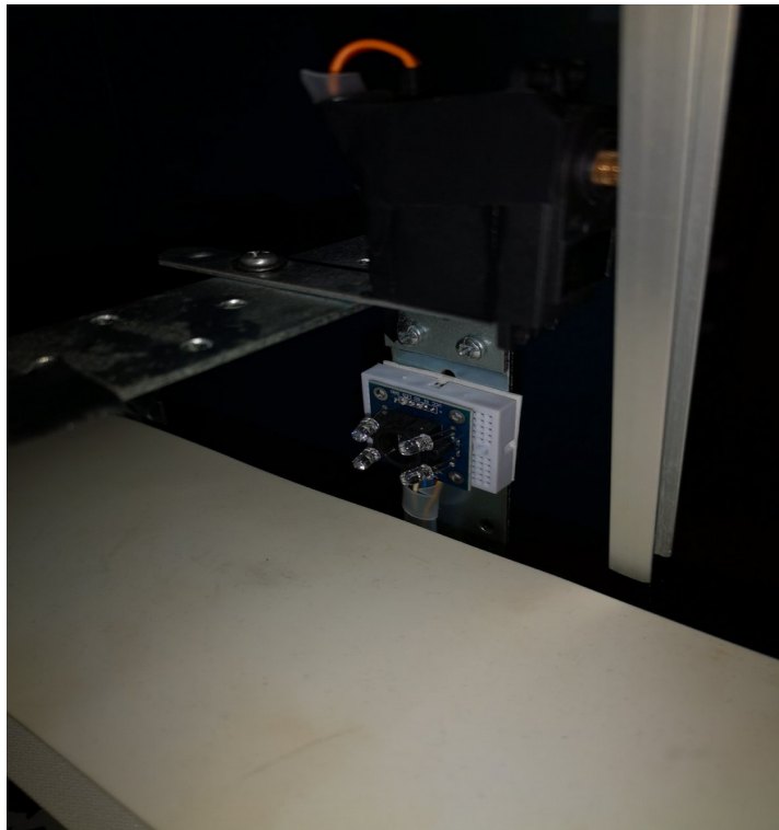
Εικόνα 36. Μεταλλικά στηρίγματα Αισθητηρίου Χρώματος-Servo
