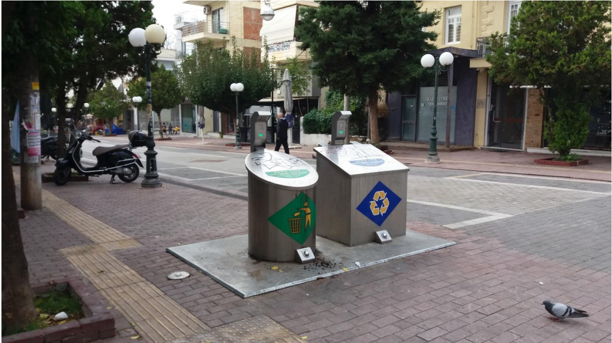
Εικόνα 73: Δίδυμο Υπόγειο Σύστημα Αποκομιδής Απορριμμάτων
