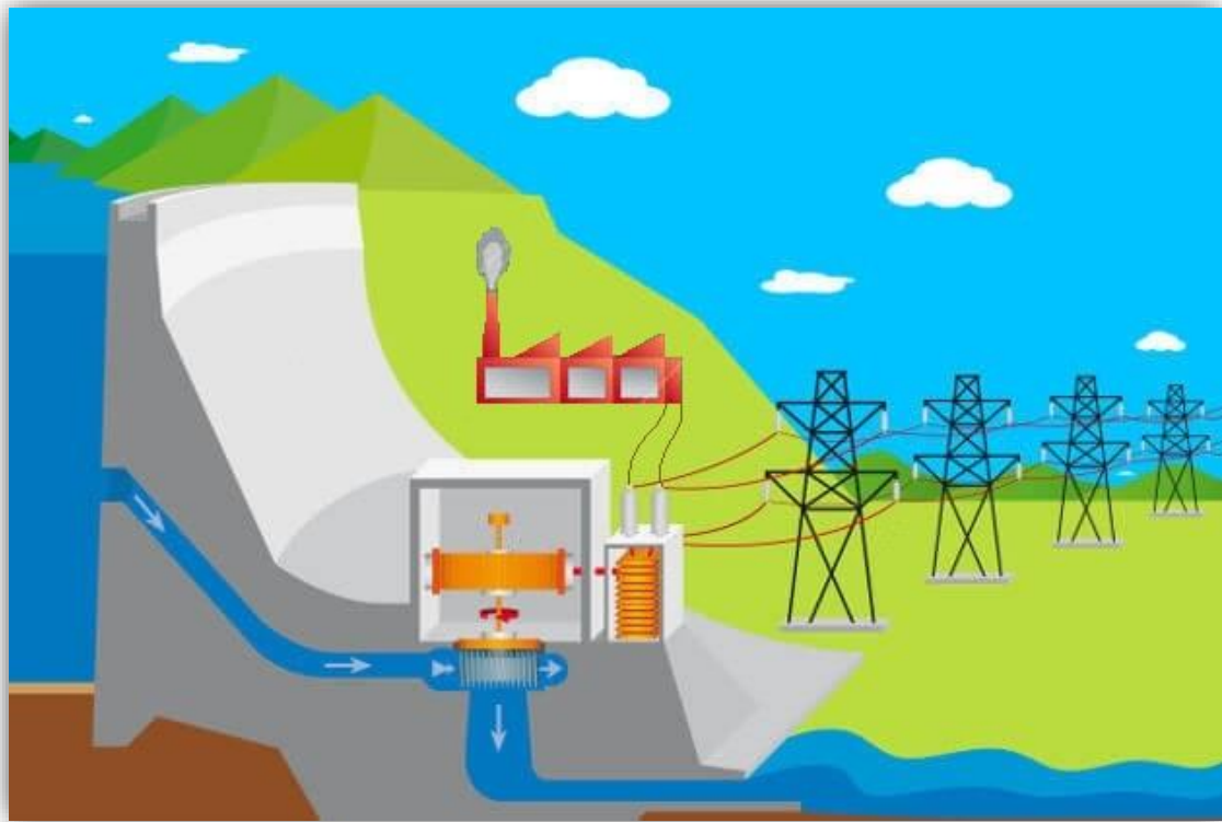
Εικόνα 32: Υδροηλεκτρικός σταθμός που τροφοδοτεί βιομηχανική μονάδα και παράλληλα είναι συνδεδεμένος με το δίκτυο
