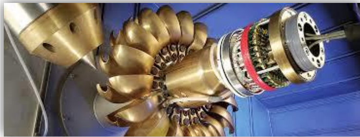
Εικόνα 18: Υδροστρόβιλος τύπου Pelton με ένα ακροφύσιο
