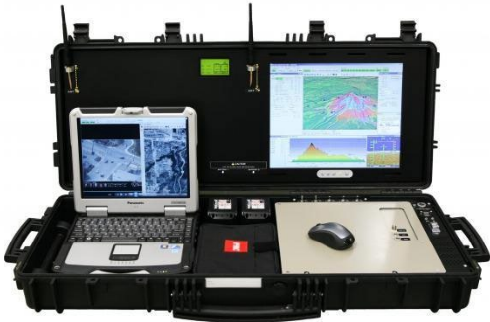
Εικόνα 50 : Φορητός σταθμός εδάφους (UAV factory)
