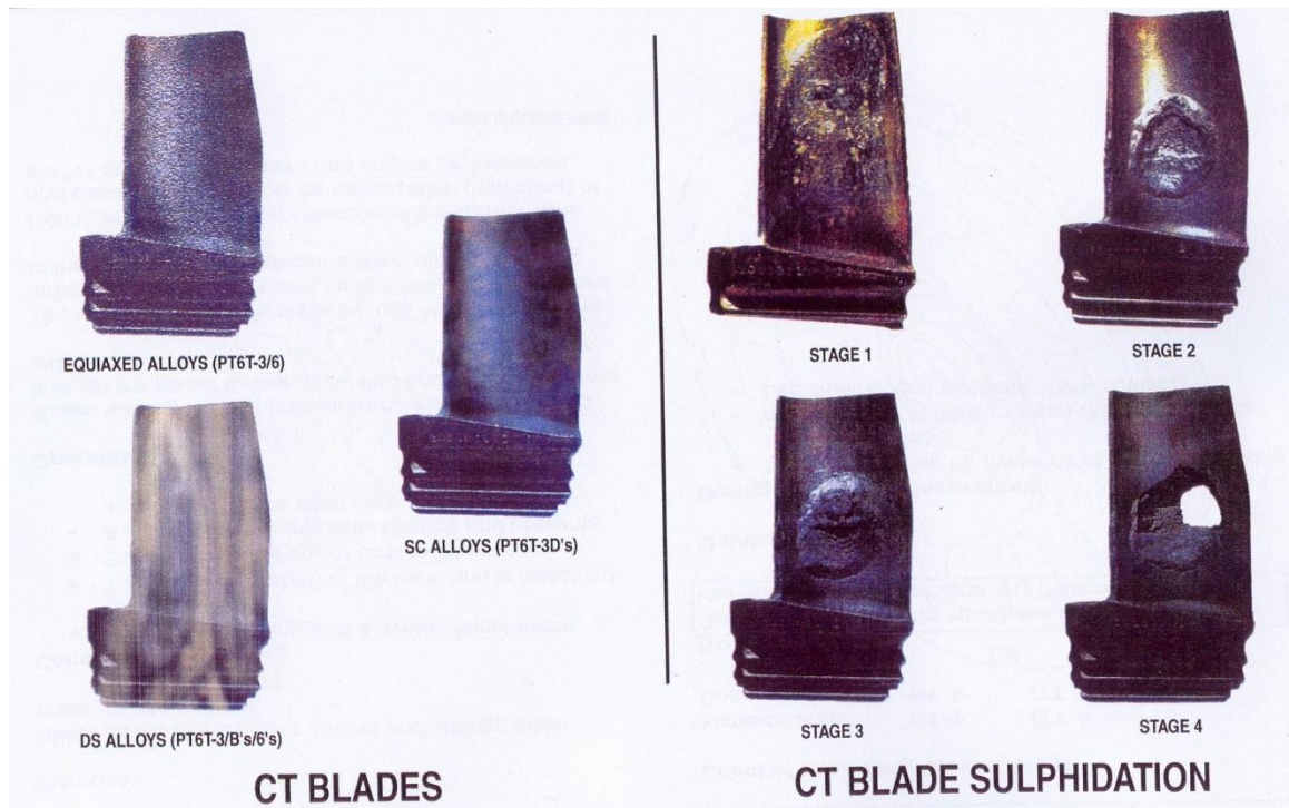
Εικόνα 48- Οξειδωση Πτερυγίων Λογο Υψηλών Θερμοκρασιών.
