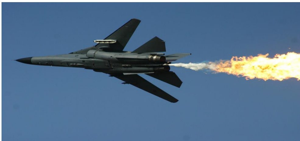
Εικόνα 17- F111 με πτέρυγες μεταβαλλόμενου βέλους
