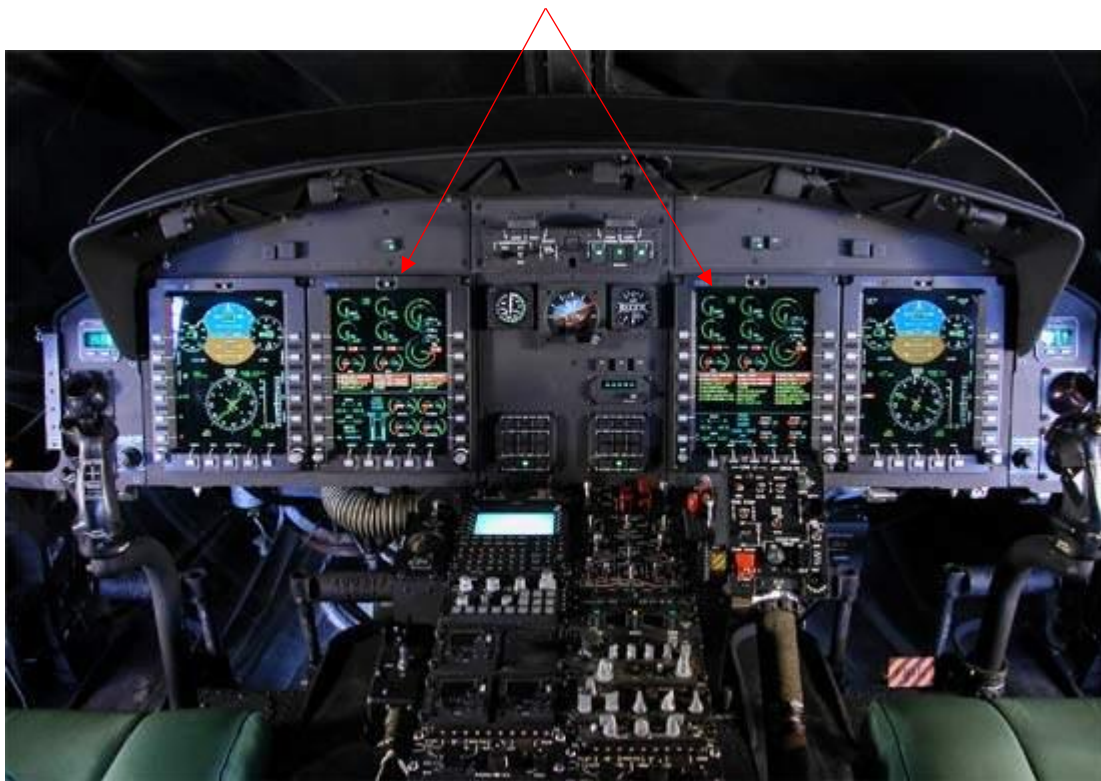
Εικόνα 41 Οθόνες Προβολής Σημάτων Ελέγχου Κινητήρα Στο Πιλοτήριο
