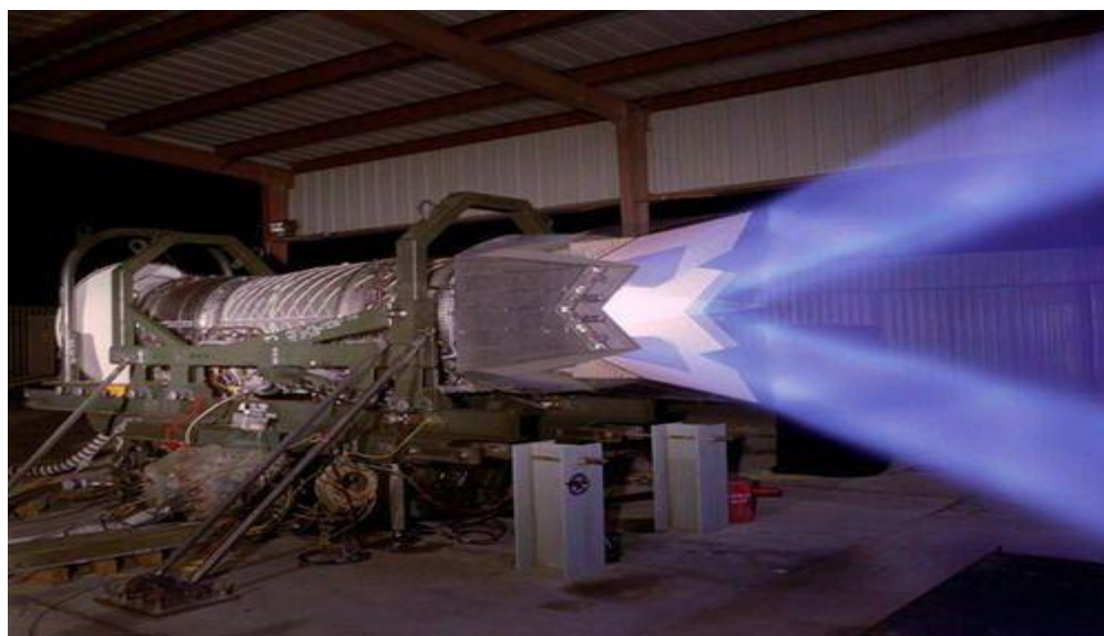
Εικόνα 25- Ακροφύσιο μεταβλητής διεύθυνσης εξαγωγής καυσαερίων (A/K F119 της P&W)*
