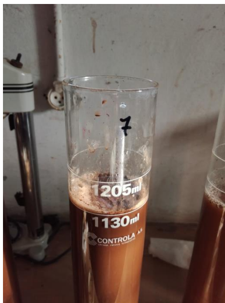
Εικόνα 45: Ο σωλήνας Βουγιούκου συμπληρωμένος με απιονισμένο νερό μέχρι τα 1,130 mL μέσα στον οποίο φαίνεται το πυκνόμετρο.
