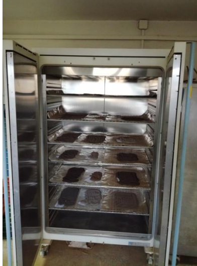
Εικόνα 43: Θάλαμος αεροξήρανσης δειγμάτων
