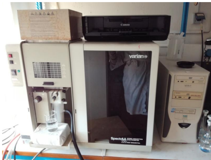
Εικόνα 50: Φασματοφωτόμετρο ατομικής απορρόφησης με φλόγα (VarianSpectraAA 220).
