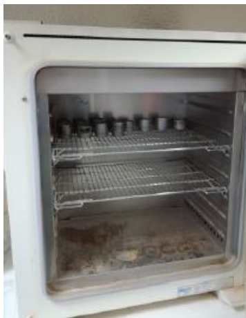
Εικόνα 44: Φούρνος όπου πραγματοποιήθηκε η ξήρανση των 10 g των ιζημάτων
