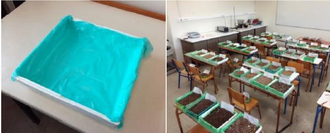
Εικόνα 41: Το επίπεδο δοχείο καλυμμένο με υλικό από πολυαιθυλένιο όπου τοποθετήθηκε το δείγμα ιζηματος (αριστερά) και τα απλωμένα δείγματα (δεξιά).
