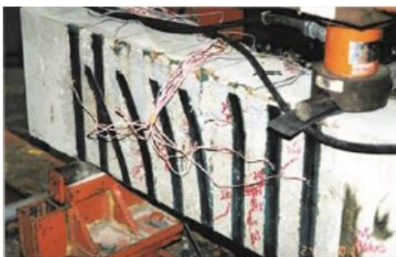
Σχ. 3.5 Αποκόλληση οπλισμών διάτμησης
