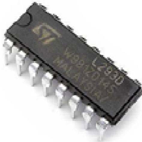
Σχήμα 4.2 - Το ολοκληρωμένο κύκλωμα L293D που χρησιμοποιήσαμε στην κατασκευή
