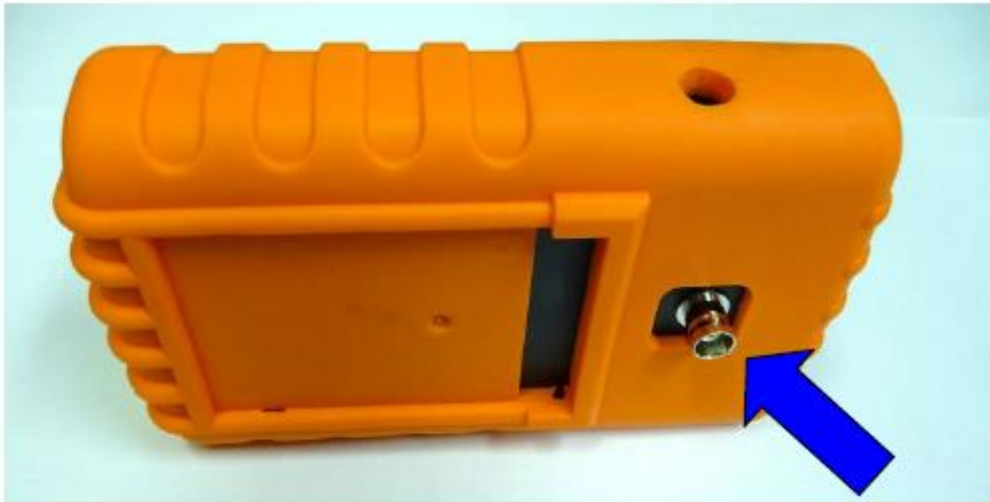
Σχήμα 27. BNC σύνδεση για το μικρόφωνο. .
