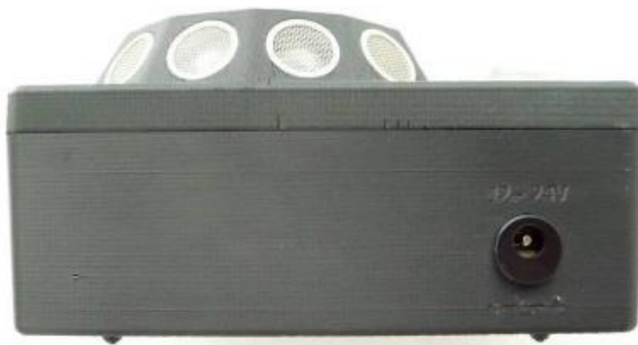
Σχήμα 25. Εξωτερική τροφοδοσία 12-24 V.
