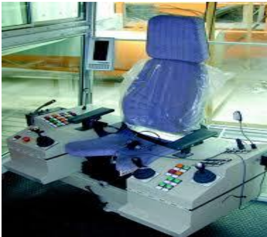
Εικόνα 5: .Κονσόλα χειρισμού γερανογέφυρας.
