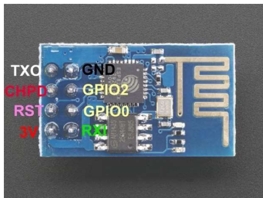
Εικόνα 3.10: Οι ακροδέκτες του ESP-8266
