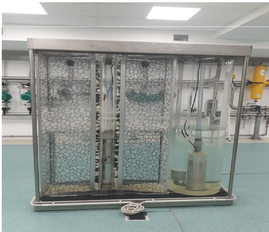
Εικόνα 7.5: Τμήμα Αντλιών Γεώτρησης(Πηγή: Αίθουσα πρακτικής Wilo Hellas)
