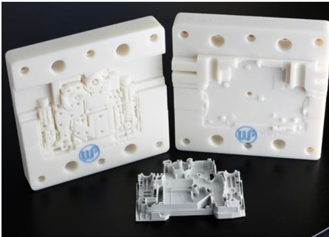
Εικόνα 12: Καλούπι κατασκευασμένος με τεχνολογία προσθετικής Κατασκευής (SpecialChem, 2016)
