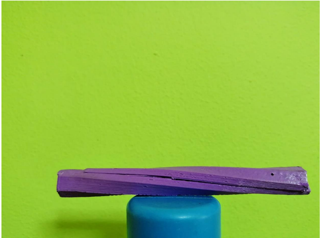
Εικόνα 103: Αποτέλεσμα πειράματος στρέψης σε ράβδο Simplify 3D
