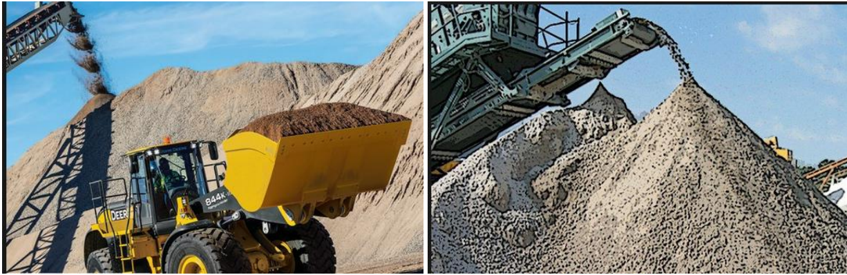
Εικόνα 3-2: Εξοπλισμός μονάδων επεξεργασίας ΑΕΚΚ- φορτωτής και μεταφορική ταινία (πηγή http://www.easa-ike.gr/ )
