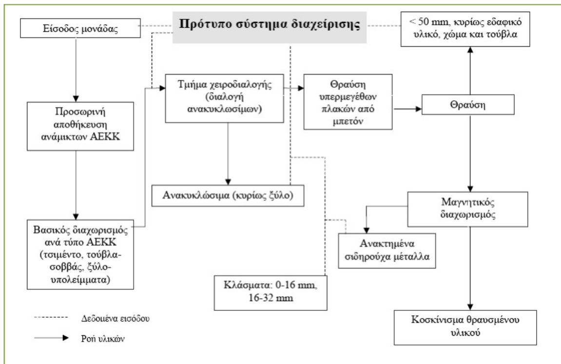
Διάγραμμα 3-2: Διάγραμμα ροής της μονάδας ανακύκλωσης ΑΕΚΚ (πηγή Ομάδα εργασίας ΤΕΕ, 2012)
