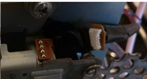
Εικόνα 2. Κόλληση σε κλιπ των τεσσάρων pins
