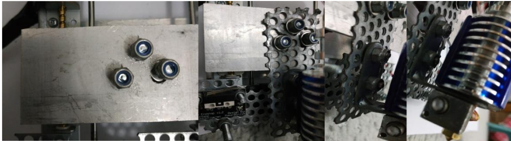
Εικόνα 28 - Σύνδεση Hot End με z άξονα
