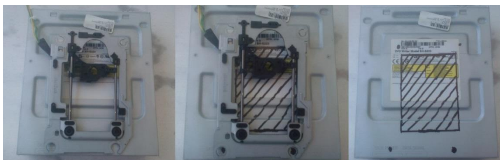
Εικόνα 20 – Τοποθέτηση γ άξονα σε βάση
