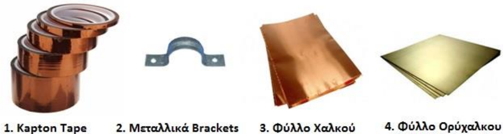
Εικόνα 31 – Υλικά κατασκευής θερμαινόμενης βάσης
