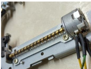
Εικόνα 1. Κόλληση απευθείας πάνω στις φάσεις του κινητήρα
