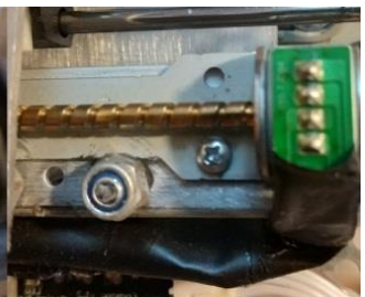
Εικόνα 3. Κόλληση απευθείας πάνω στο flex cable χωρίς χρήση επιπλέον κλιπ
