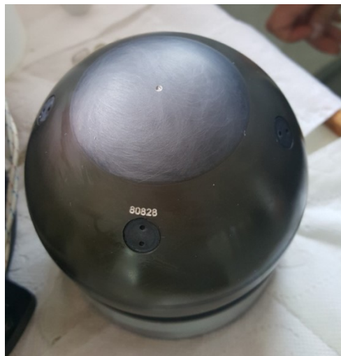
Εικόνα 9. Η σφαίρα της πυξίδας μέσα στην οποία υπάρχουν τα δύο γυροσκόπια.
