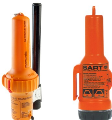
Εικόνα 52. Αριστερά συσκευή SART με μηχανισμό ενεργοποίησης δαχτυλίδι (O ring) και δεξιά SART με μηχανισμό ενεργοποίησης διακόπτη
