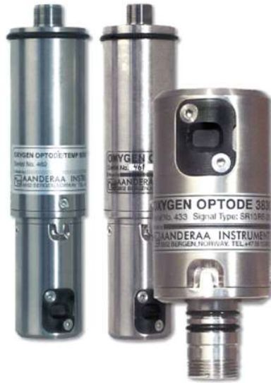
Εικόνα 16. Εικόνα τυπικού οπτοδίου οξυγόνου
