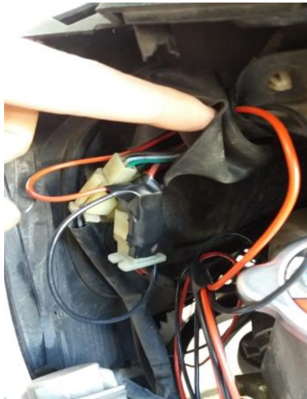
Εικόνα 5.10 Βραχυκύκλωση ακροδεκτών Ignition Switch (κλειδί)
