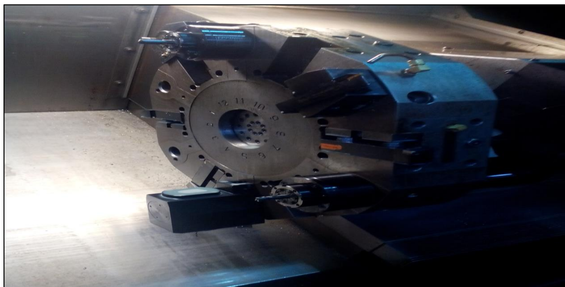
Εικόνα 22 Εργαλειοφορέιο τόρνου CNC της εταιρίας HAAS, μοντέλο SL40
