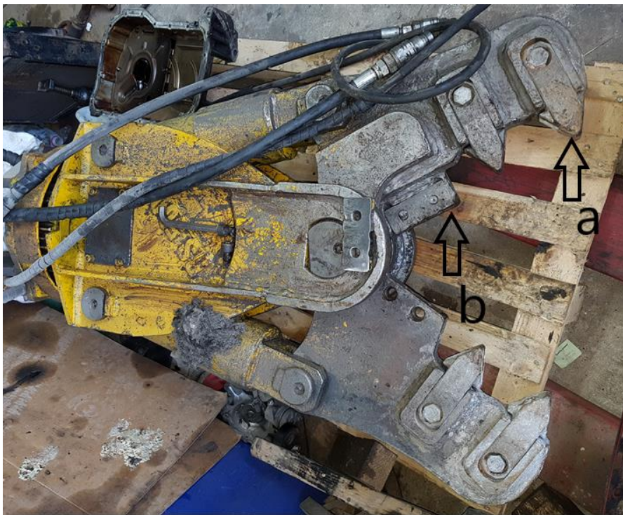
Εικόνα 3.2 Γενική άποψη της διάταξης, όπου a τα κωνικά εξαρτήματα και b τα εξαρτήματα γεωμετρίας ορθογωνίου παραλληλεπιπέδου.
