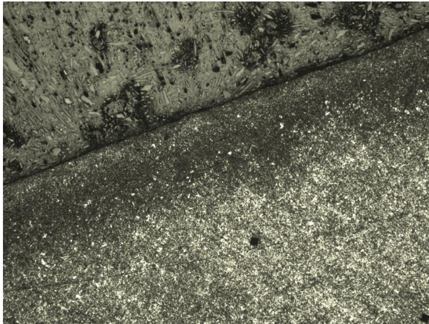
Εικόνα 5.25. Επιφάνεια θραύσης η οποία δεν παρουσιάζει πλαστική παραμόρφωση A3_x50_picral.
