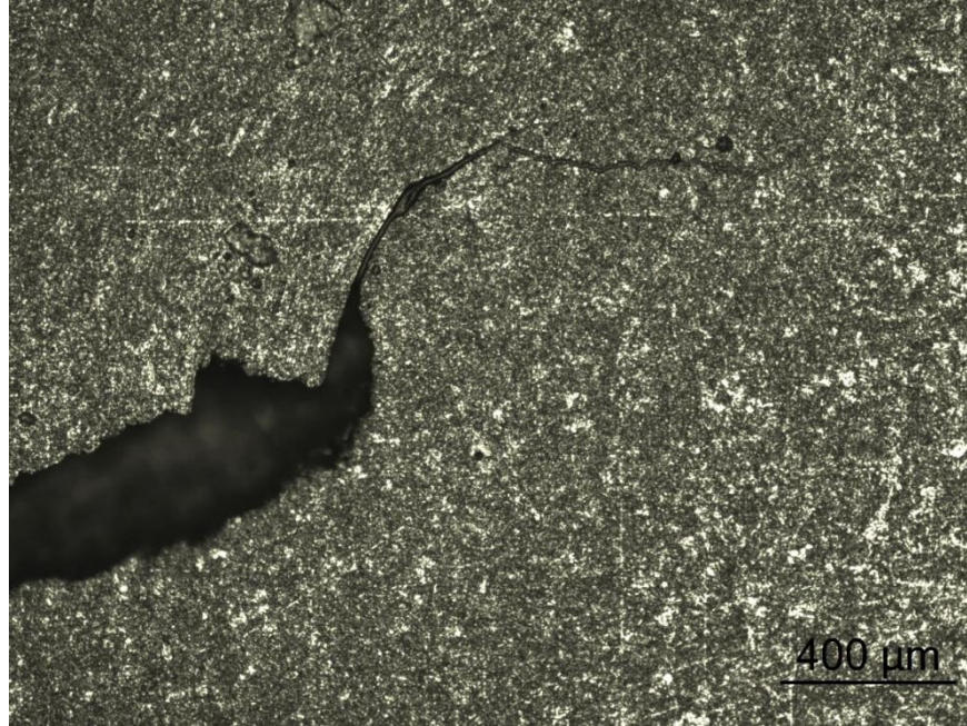
Εικόνα 5.14 Έντονη πλαστική παραμόρφωση και ρηγμάτωση Al 56 D_x 200_Pical
