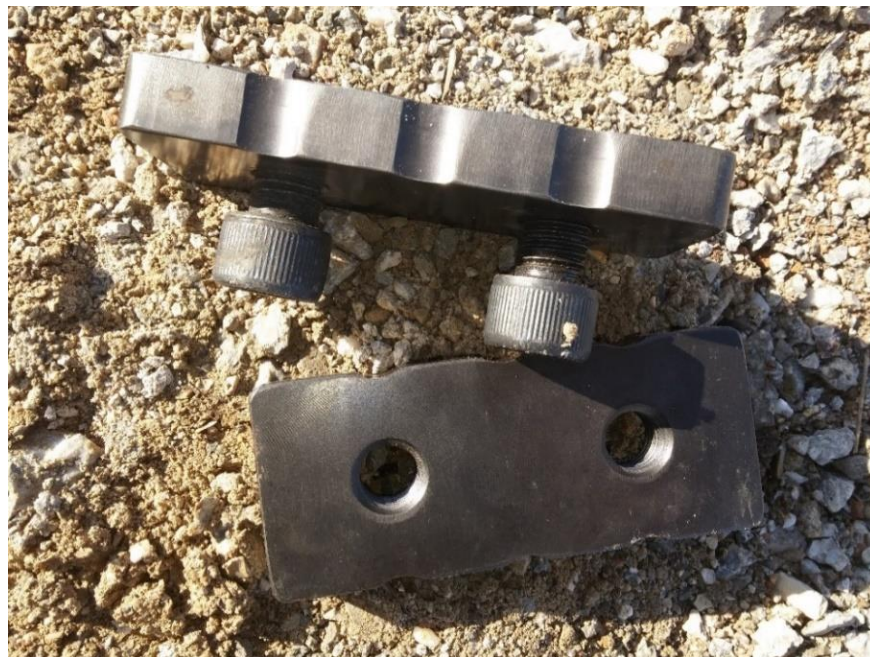
Εικόνα 3.4 Γενική άποψη ζεύγους κοπτικών εξαρτημάτων με κοχλίες συγκράτησης
