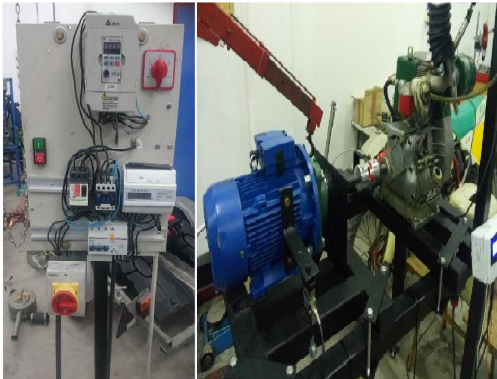
Εικόνα 3.1: Πίνακας ελέγχου και ολοκληρωμένη διάταξη δυναμοπέδης.
