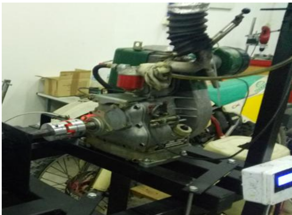
Εικόνα 2.1.1: Κινητήρας Lister Petter AA1.
