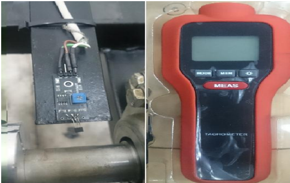
Εικόνα 2.4.2: Αισθητήρας στροφών arduino και εξωτερικό ταχύμετρο.
