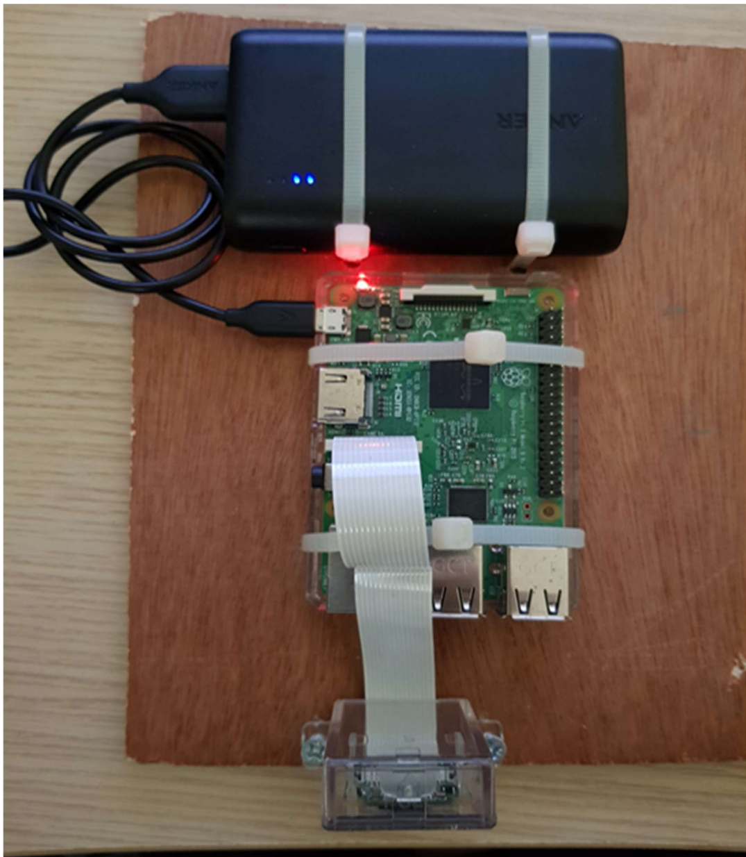
Εικόνα 12. Κατασκευή RPi 3 με camera module και power bank για τροφοδοσία.
