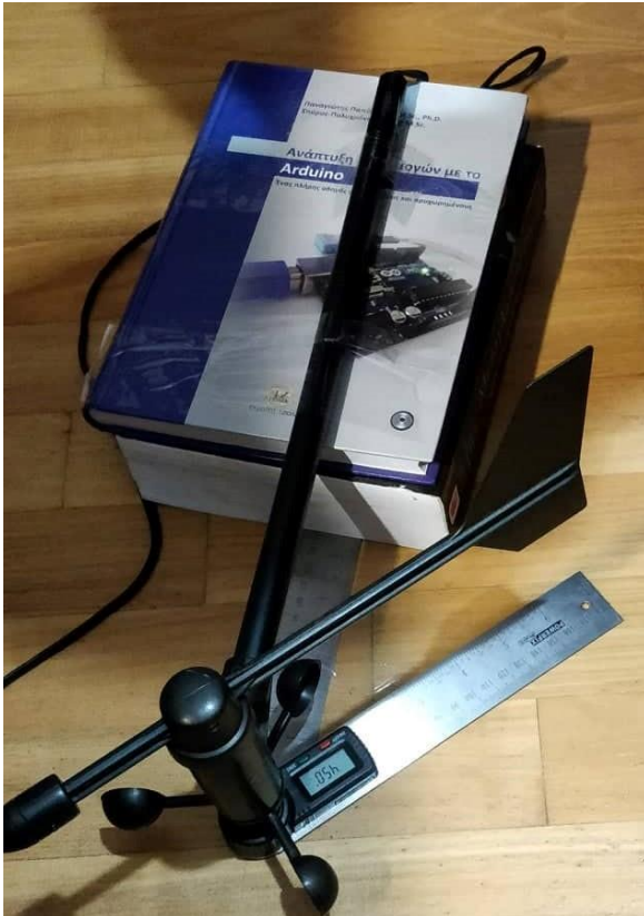
Εικόνα 19: Η διαδικασία βαθμονόμησης του ανεμοδουρίου
