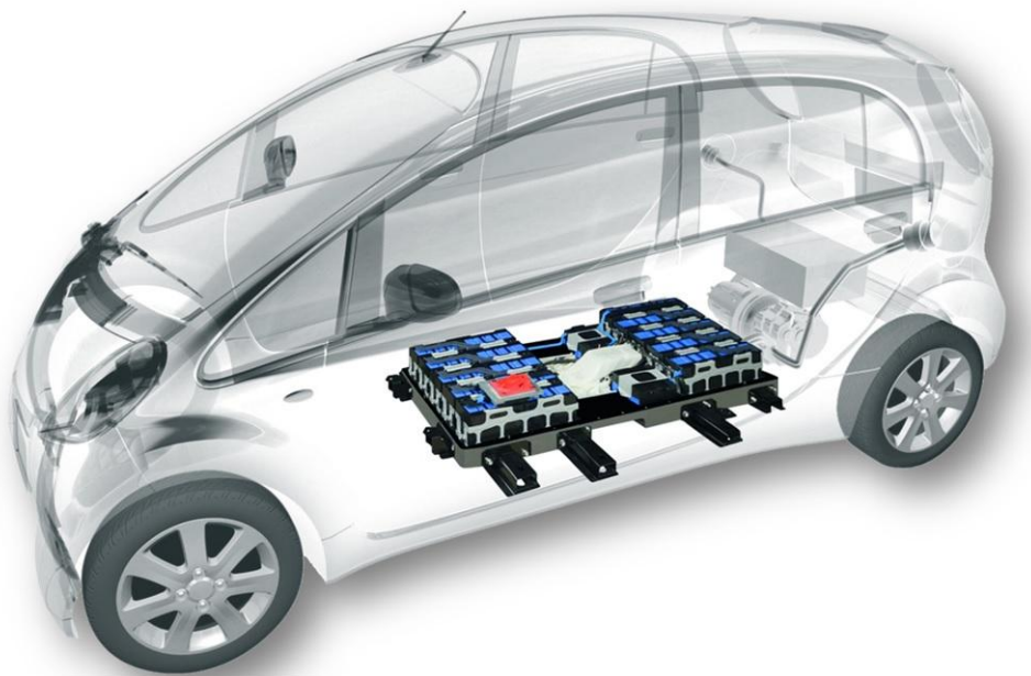
Εικόνα 4.9 Τοποθέτηση συστήματος μπαταρίας στο δάπεδο του ηλεκτρικού οχήματος [41]
