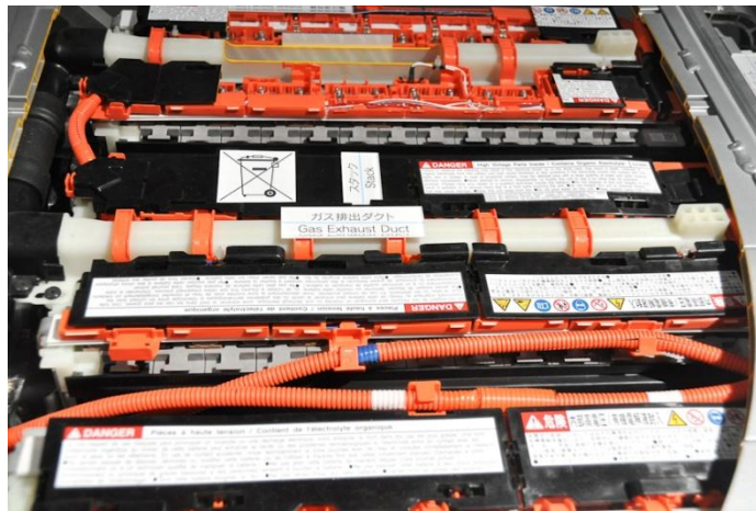
Εικόνα 2.6 Μπαταρία υβριδικού οχήματος
