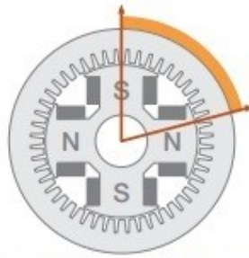
Κάθε σπείρα καταλαμβάνει 10 'δόντια' Winding Pitch (κούρδισμα) = 10/12
