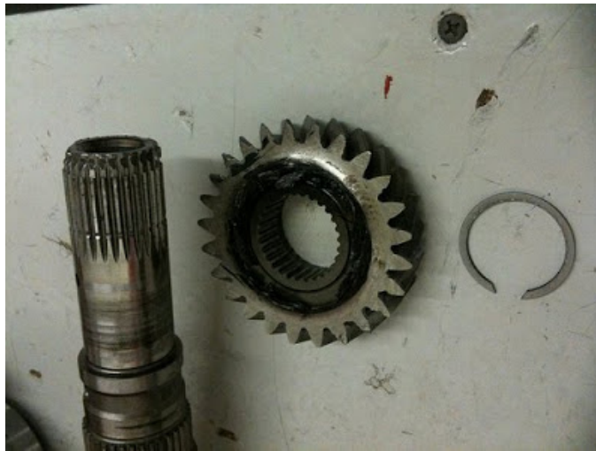
Εικόνα 4.1: Ρήγμα σε δόντια γραναζιού από κιβώτιο ταχυτήτων γεννήτριας
