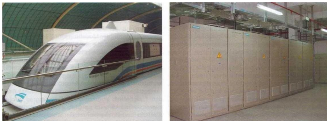
Σχ.1.3 Το μαγνητικό τρένο "Transrapid" στη Σαγκάη (Κίνα) το έτος 2003, 430 km/h, πρώτη εμπορική εφαρμογή στον κόσμο. Δεξιά φαίνεται το σύστημα των ηλεκτρονικών μετατροπέων ισχύος για την τροφοδοσία των γραμμικών
