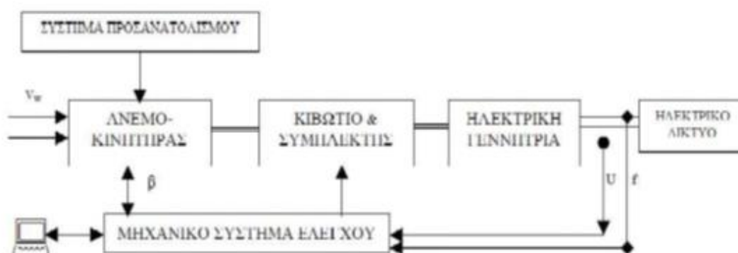
Σχ. 2.2: Βασική δομή συστήματος σταθερών στροφών-σταθερής συχνότητας
