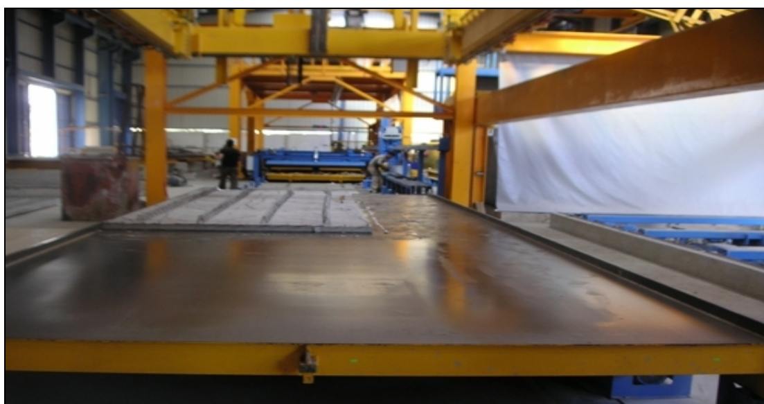
Εικ. 107 Εργασία παραγωγής δομικού στοιχείου
