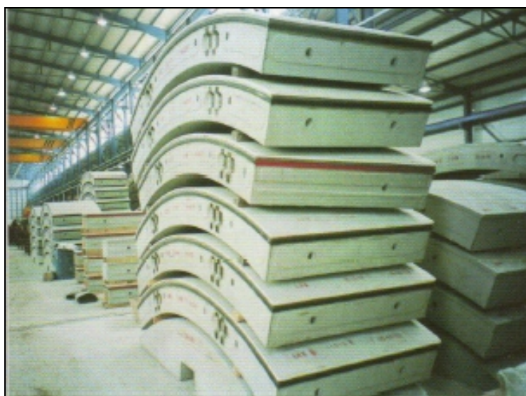
Εικ. 111 Αποθήκευση δομικών στοιχείων σε στρώσεις
