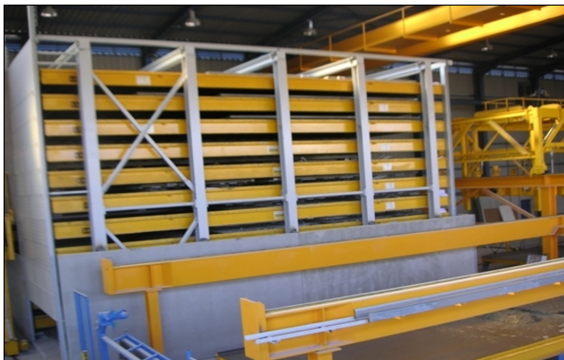
Εικ. 110 Αποθήκευση δομικών στοιχείων σε στρώσεις
