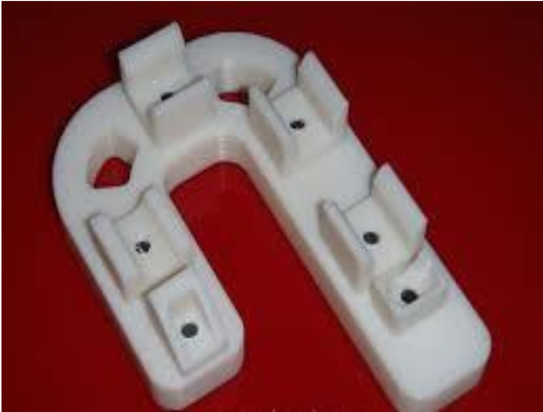
Εικόνα 37: Ιδιοσκευή συγκράτησης μικρού μεγέθους σωληνώσεων
