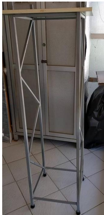
Εικόνα 6 Μεταλλικός σκελετός φρεατίου
