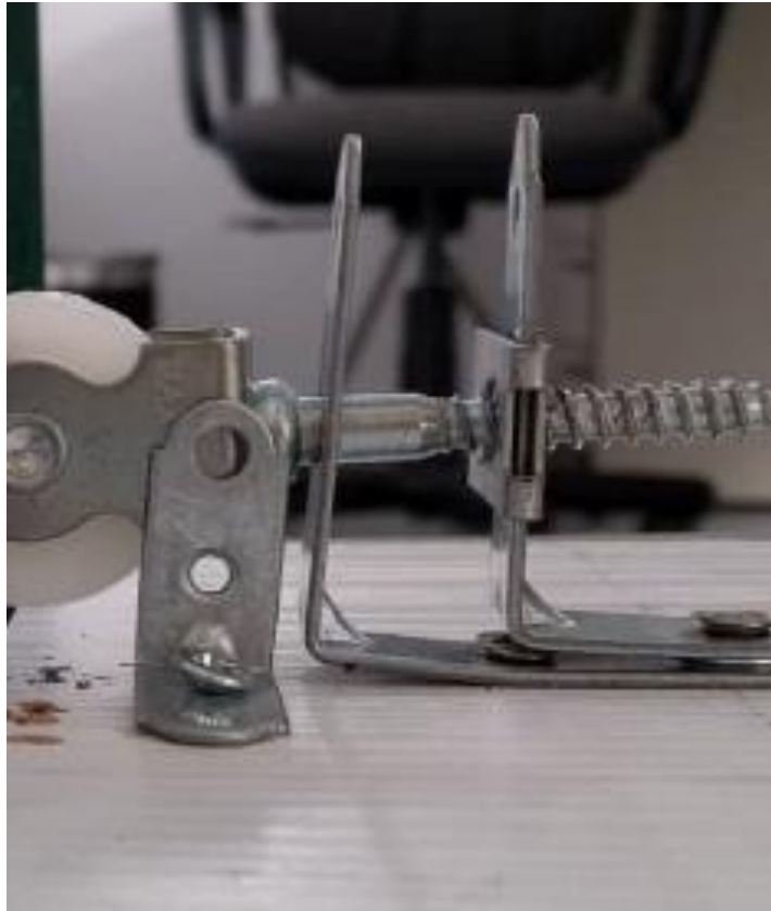
Εικόνα 16 Λεπτομέρεια μεταλλικής γωνίας ράουλων θαλάμου
