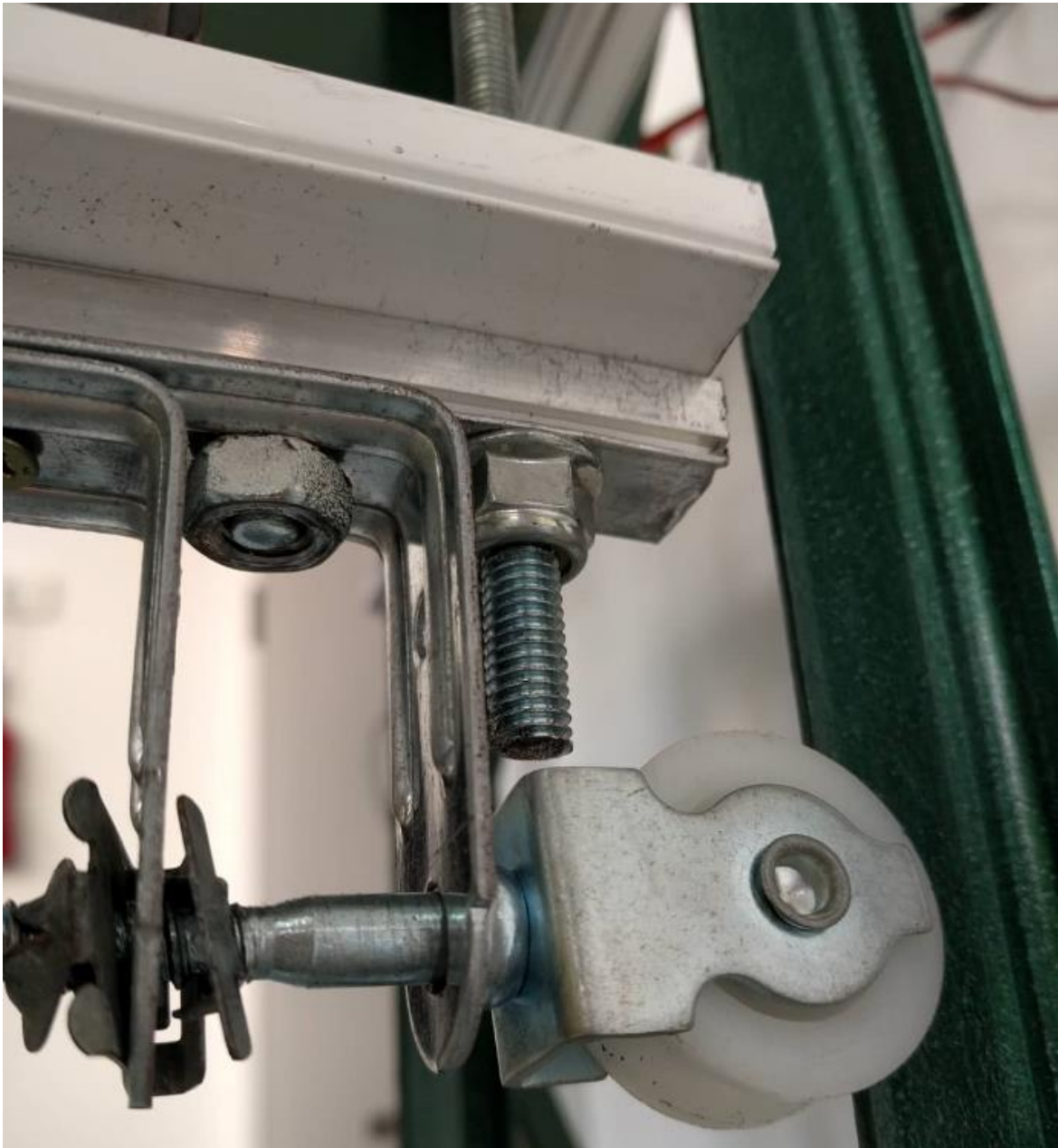
Εικόνα 19 Λεπτομέρεια ράουλου στήριξης αντίβαρου
