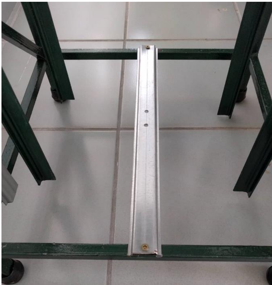
Εικόνα 12 Βάση ανάπαυσης θαλάμου στο χαμηλό όριο
