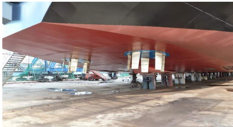
Εικόνα 2.9B Προωστήρας τύπου Voith Schneider 17
