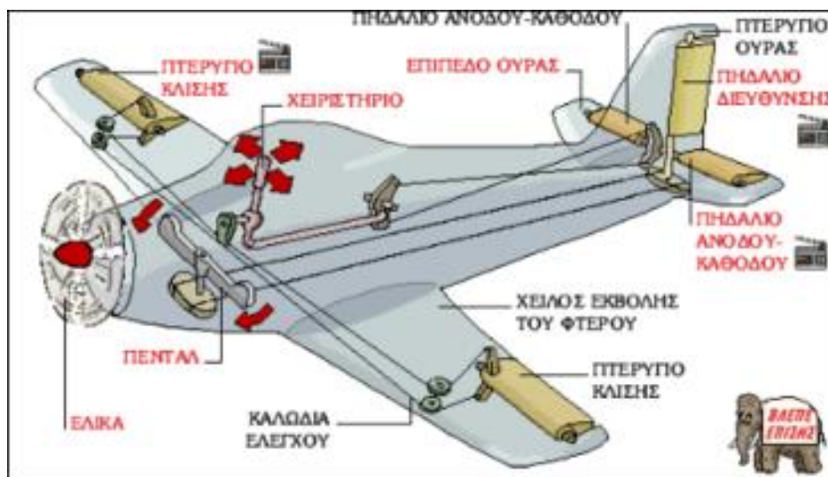
Εικόνα 4: Τα πηδάλια του αεροσκάφους
