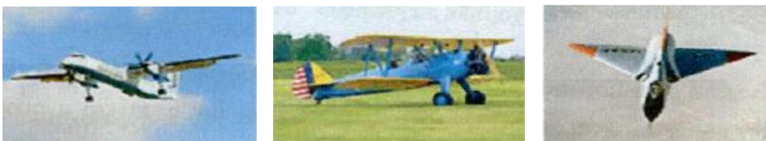
Εικόνα 3: Μονόπλανο – Αεροσκάφος με δύο επίπεδα φτερών – Αεροσκάφος με φτερά τύπου δέλτα
