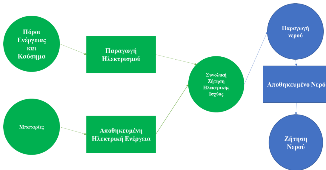
Εικόνα 1 Λειτουργία Μοντέλου Βελτιστοποίησης Εφοδιαστικής Αλυσίδας Ενέργειας & Παραγωγής Νερού (Papapostolou, Kondili and Tzanes, 2018)
