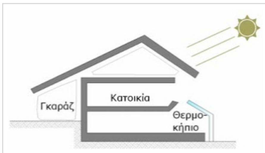
Εικόνα 19 Εσωτερική διάταξη χώρων κατοικίας- Διαγραμματική κάτοψη και τομή βιοκλιματικού κελύφους 56
