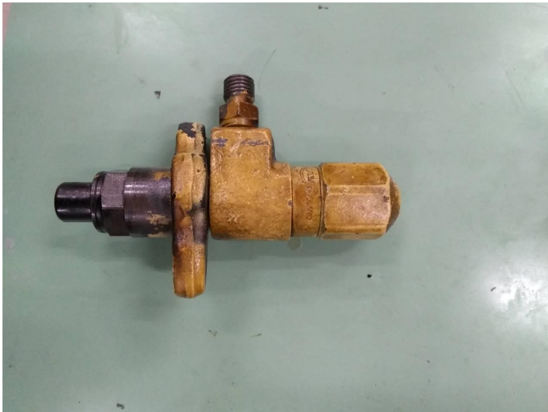
Εικόνα 11 Το σύστημα έγχυσης με την παροχή καυσίμου , το ιντζέκτορ και την βάση του εξαρτήματος που εδράζεται στην κεφαλή του κινητήρα μας. Διακρίνονται τα αρχικά C.A.V. ENGLAND που προφανώς είναι του κατασκευαστή.
