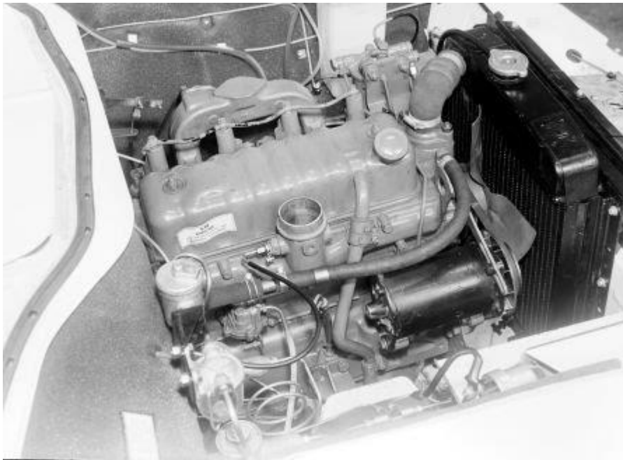
Εικόνα 8 Ο Perkins 4.99 στα μέσα της δεκαετίας το '60. Ακριβώς ίδιος με τον πειραματικό κινητήρα που ανακατασκευάσαμε. ( https://sites.google.com/site/perkinslongserviceclub/heritage-snippets/the-story-of-the-4-99-4-107-4-108-engine )
