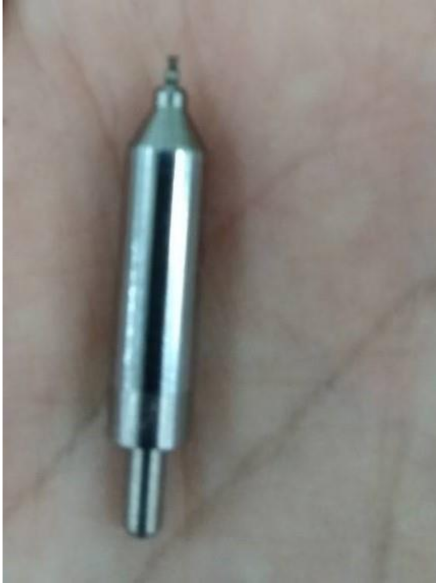
Εικόνα 13 Η ακίδα του συστήματος έγχυσης που είναι υπεύθυνη για την ατμοποίηση του καυσίμου εντός του θαλάμου καύσης .
