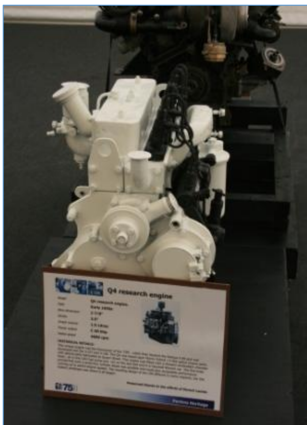
Εικόνα 4: Ο Perkins Q4 αργότερα που με το πέρασμα των δοκιμών θα αποτελέσει τον Perkins 4.99
