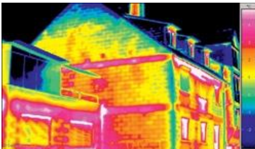
Εικόνα 26 Θερμικές απώλειες χωρίς εξωτερική θερμομόνωση
