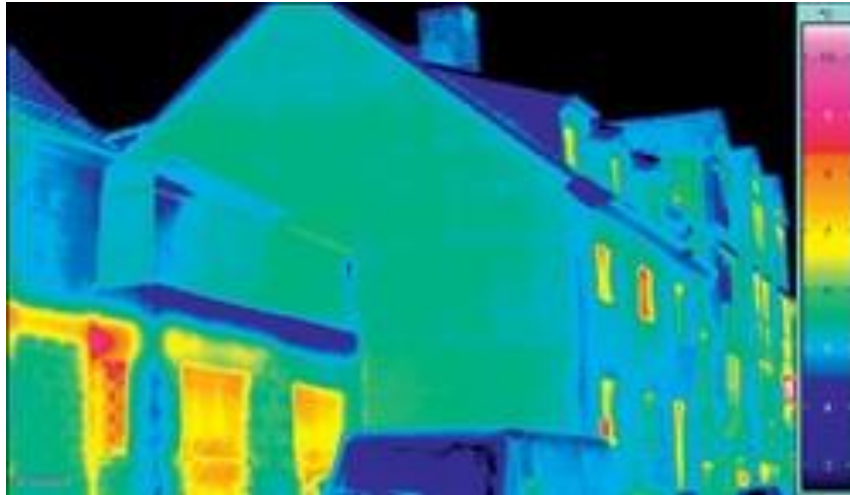
Εικόνα 27Θερμικές απώλειες με εξωτερική θερμομόνωση
