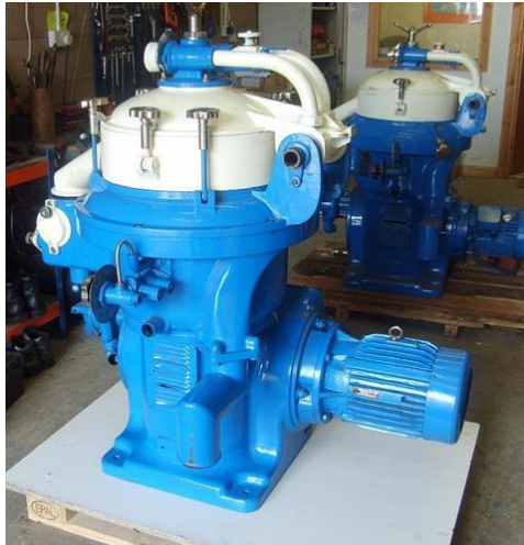
Εικόνα: Φυγοκεντρικός καθαριστής λαδιού
