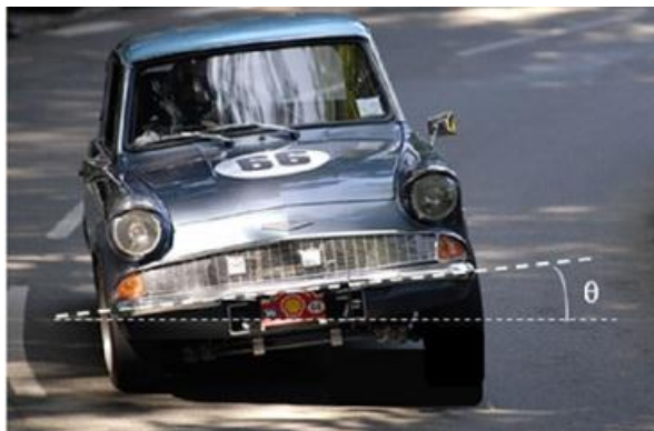
Εικόνα 2.1 : Απεικόνιση γωνίας κύλισης αυτοκινήτου.[3]
