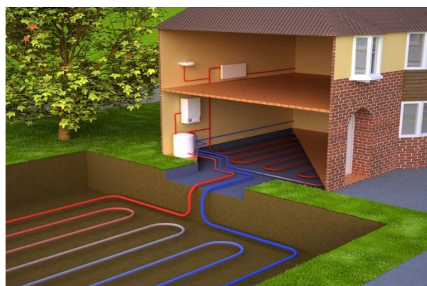
Εικόνα 1.5.2 Ενδεικτική λειτουργία γεωθερμικής εγκατάστασης. Πηγή: https://ikomek.kz/magazine/show/187
