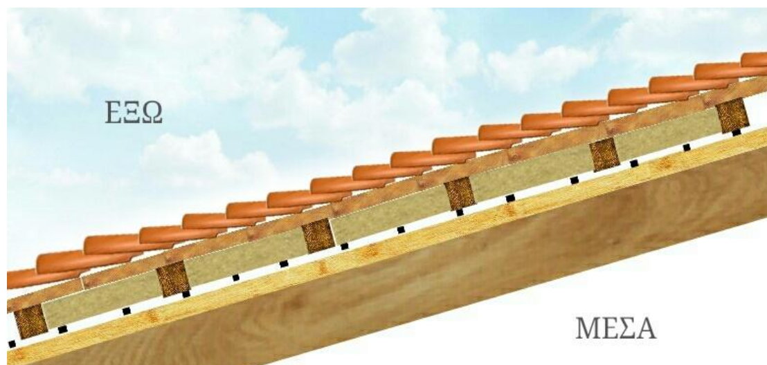
Εικόνα 2.5.13 Τελική κατάσταση ξύλινης στέγης. Πηγή: Προσωπικό αρχείο(2017)
