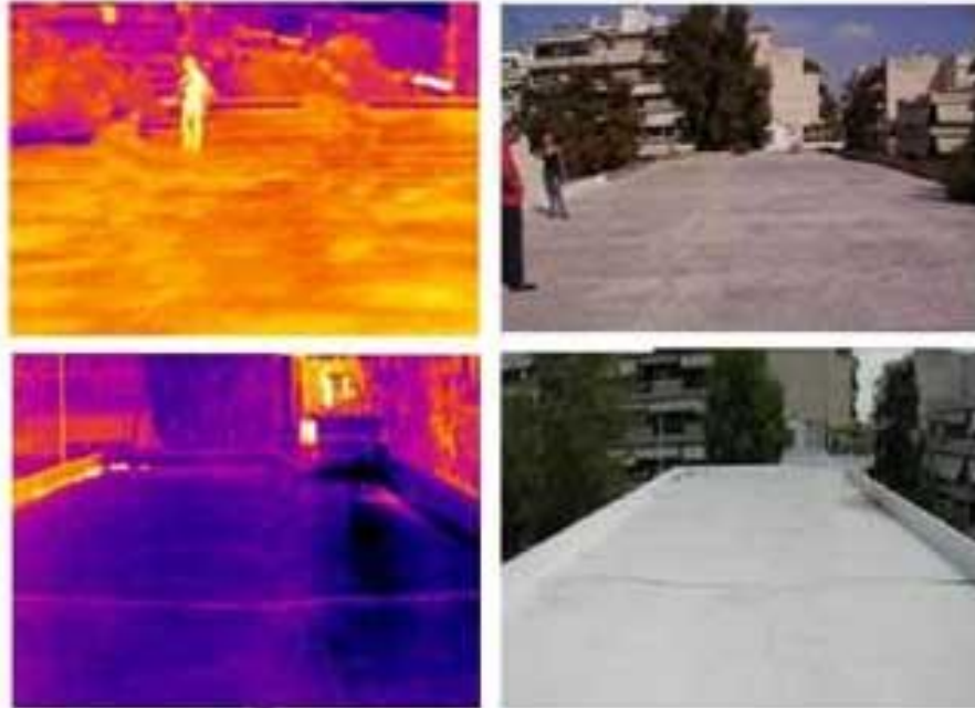
Σχήμα 17 Υπέρυθρη και ορατή απεικόνιση οροφής, που δείχνει τη διαφορά θερμοκρασίας πριν και μετά την εφαρμογή του ψυχρού υλικού
