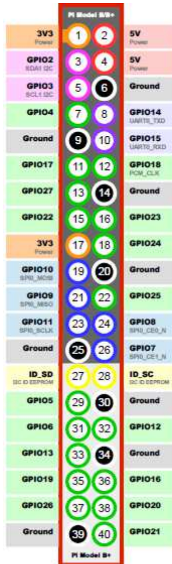
Διάγραμμα 5: Διάγραμμα GPIO του Raspberry Pi 3 model B+ [25].
