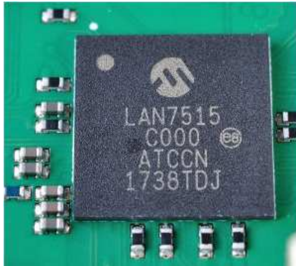
Εικόνα 7: Το ολοκληρωμένο LAN7515 της εταιρείας Microchip, υπεύθυνο για την GigabitEthernet επικοινωνία του μικροεπεξεργαστή [28].
