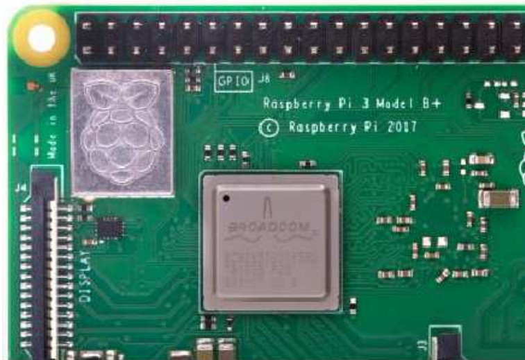
Εικόνα 5: Η μεταλλική θωράκιση με το σήμα της εταιρείας, κάτω από την οποία βρίσκεται το ολοκληρωμένο κύκλωμα ασύρματης επικοινωνίας [11].
