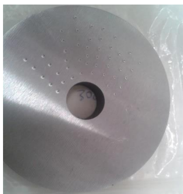
Εικόνα 10. Πρότυπο δοκίμιο ονομαστικής σκληρότητας 22,8HRC
