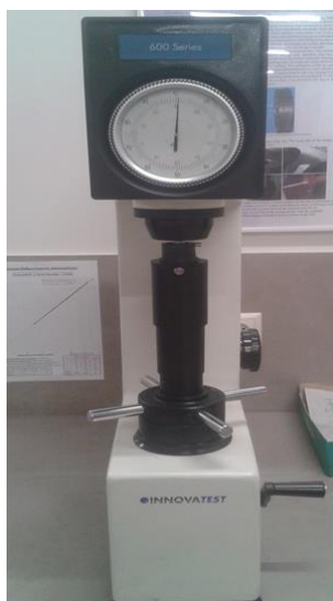
Εικόνα 9. Απεικόνιση του προς μελέτη σκληρομέτρου Innovatest 600A, s/n 13154.
