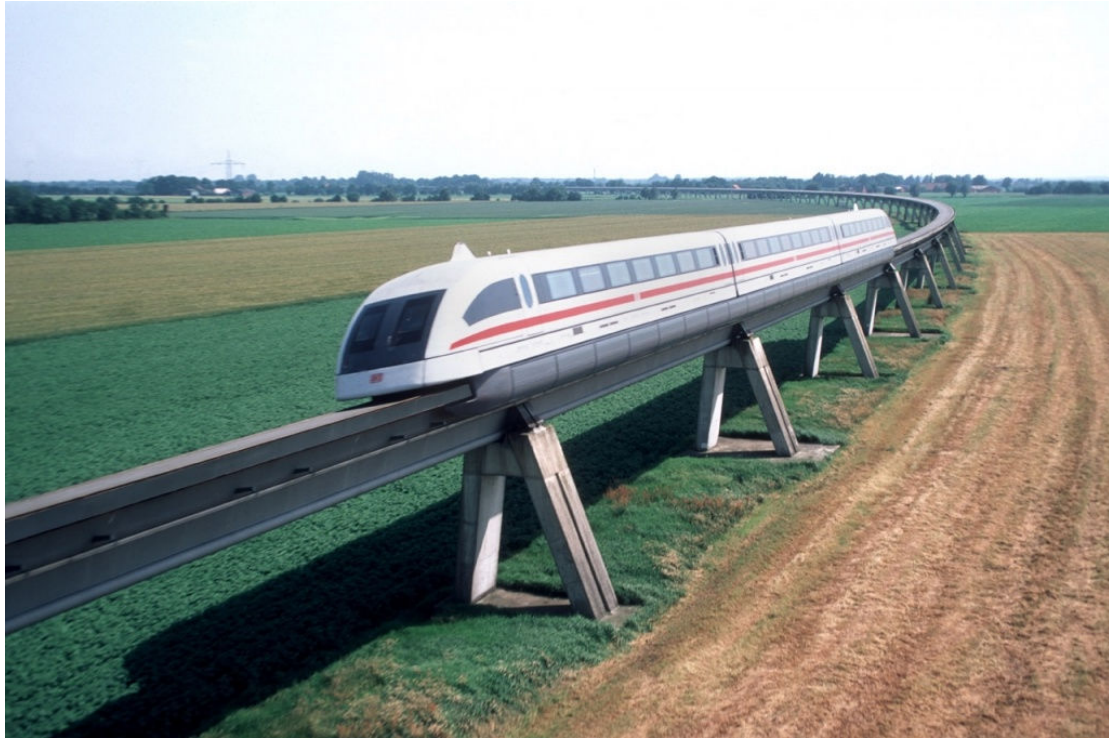
Εικόνα 21. Το Γερμανικό σύστημα Transrapid χρησιμοποιεί σερβομηχανισμούς, ώστε να προκαλέσει αιώρηση του τρένου και να διατηρήσει σταθερό κενό, την ώρα που το όχημα κινείται με μεγάλη ταχύτητα
