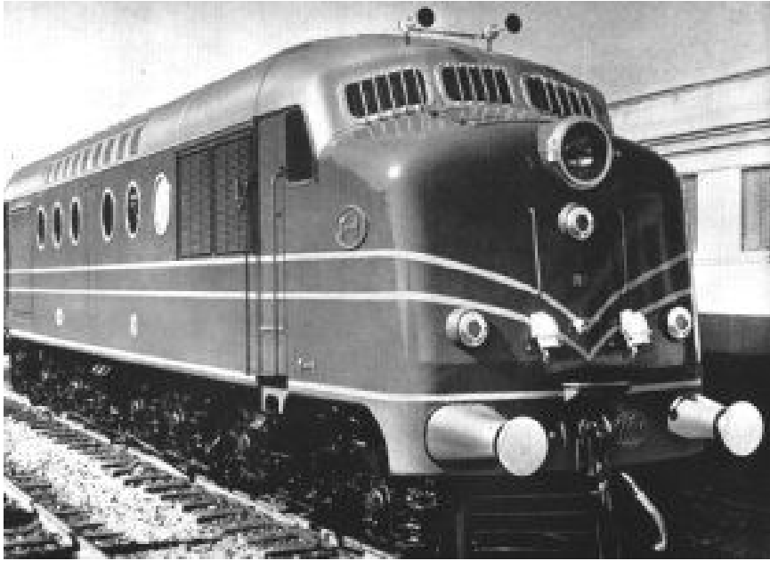
Εικόνα 50. Ένα από τα πρώτα τρένα που χρησιμοποιούσαν κινητήρες Diesel και ηλεκτρογεννήτριες
