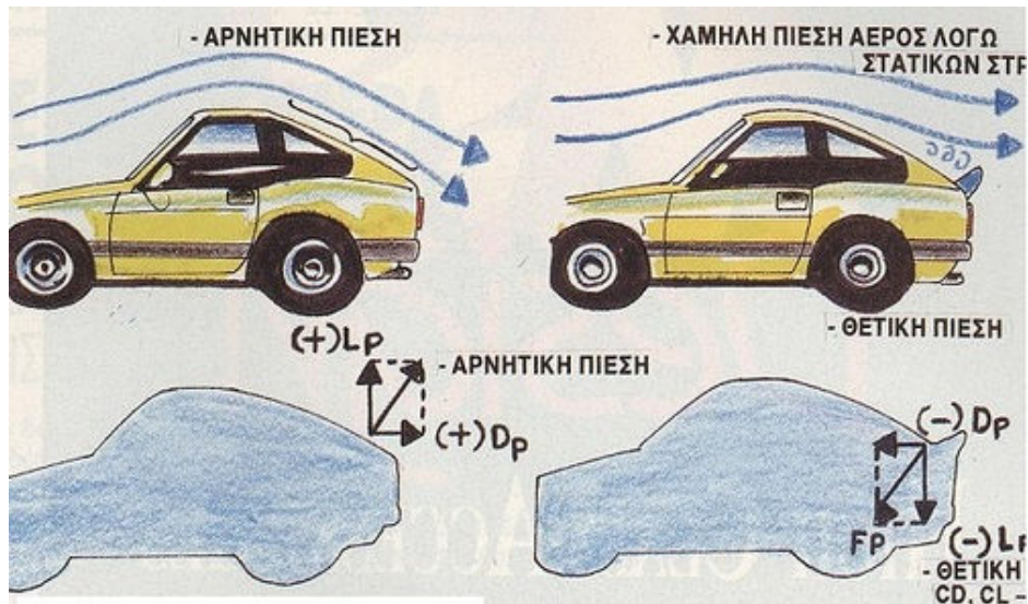
Εικόνα 18. Η χρησιμοποίηση αεροτομής, βελτιώνει την αεροδυναμικότητα του αμαξώματος
