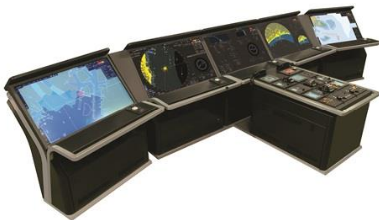
Εικόνα 1. Τυπικό Ολοκληρωμένο Σύστημα Γέφυρας εμπορικού πλοίου
