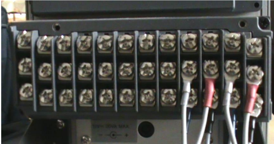
Εικόνα 3-20 Σύνδεση δύο αισθητήρων θερμοροής – θερμοκρασίας
