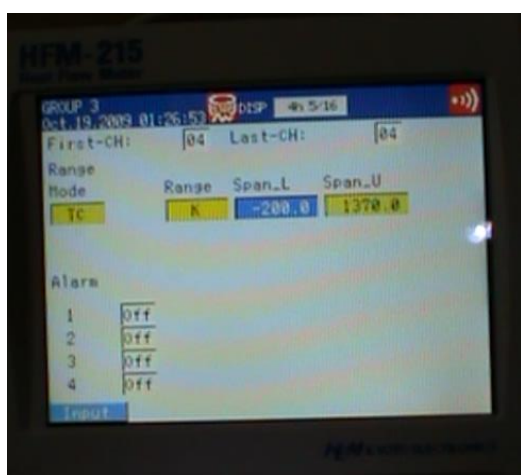
Εικόνα 3-29 Ρύθμιση τύπου αισθητήρα θερμοζέυγους
