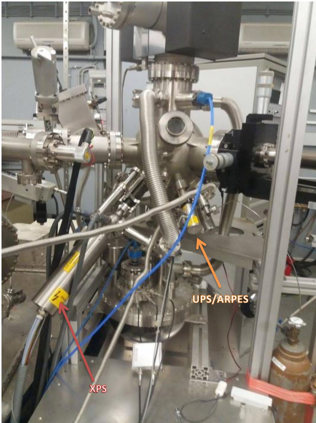
Εικόνα 3.10. Ο θάλαμος με τα UPS/ARPES και XPS του Εργαστηρίου Επιταξίας και Επιστήμης Επιφανείων στο Ε.Κ.Ε.Φ.Ε. «Δημόκριτος».
