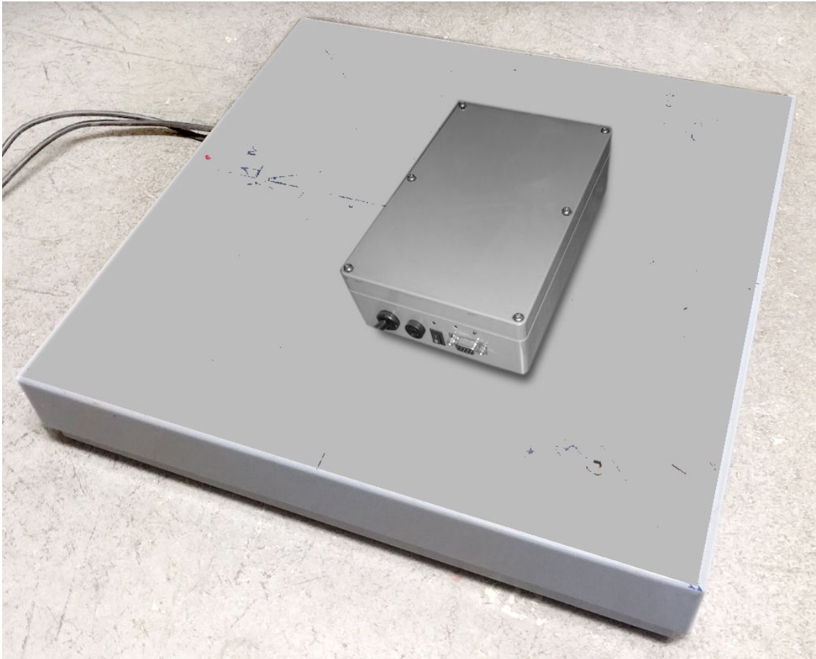
Φωτ 1.1 Πλατφόρμα και ηλεκτρονικό μέρος του οργάνου
