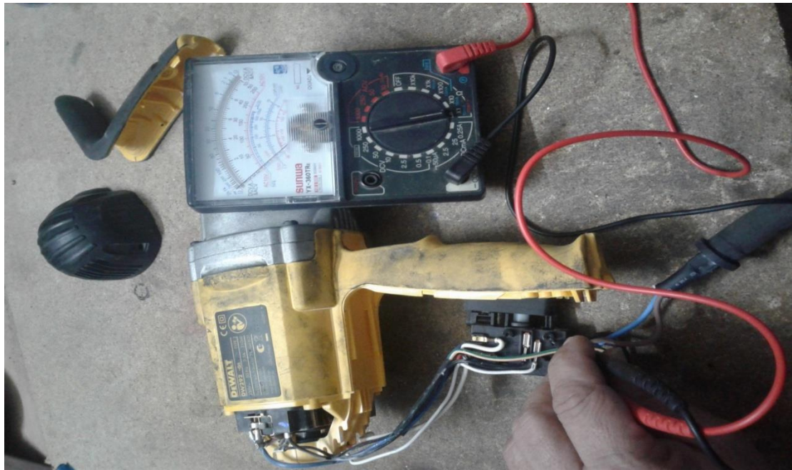
Εικόνα 40 Έλεγχος επαφών διακόπτη λειτουργίας
