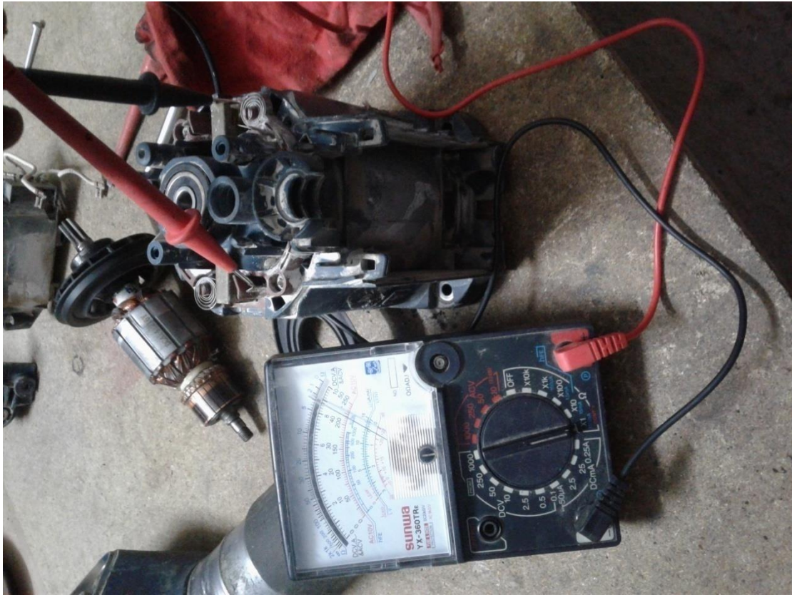
Εικόνα 56 Διαδικασία ελέγχου πηνίου στάτη
