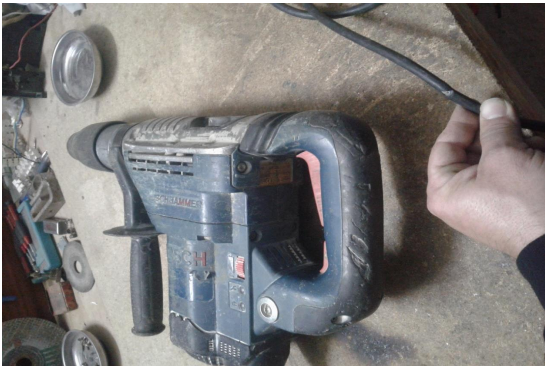
Εικόνα 49 Οπτικός έλεγχος καλωδίου
