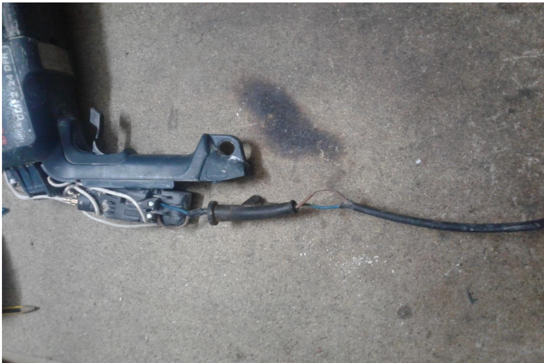
Εικόνα 26 Έλεγχος καλωδίου και ακροδεκτών ρευματολήπτη
