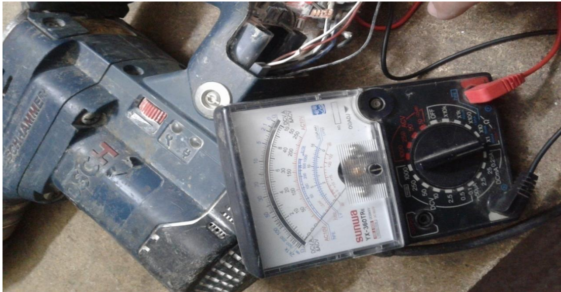
Εικόνα 50 Διαδικασία έλεγχου μπουτόν λειτουργίας ηλεκτρικού σκαπτικού (NO επαφή)
