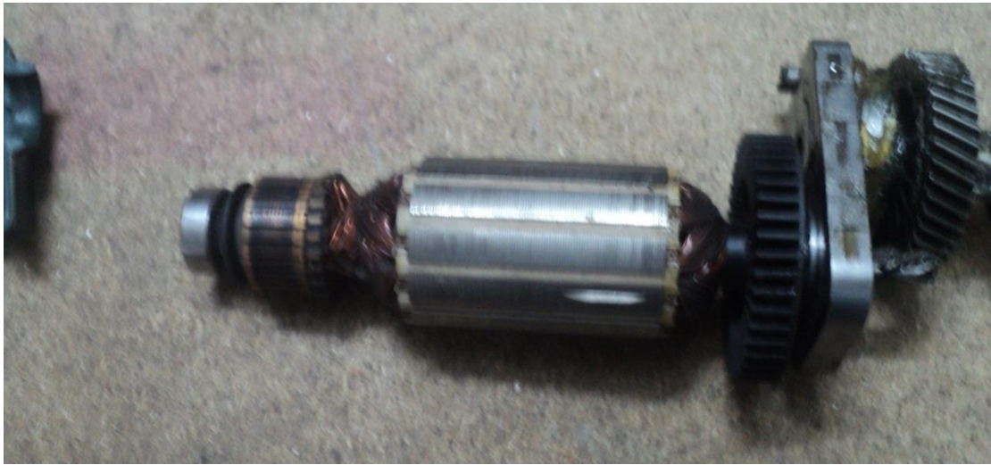
Εικόνα 9 Έλεγχος Πηνίου Περιστροφικού άξονα
