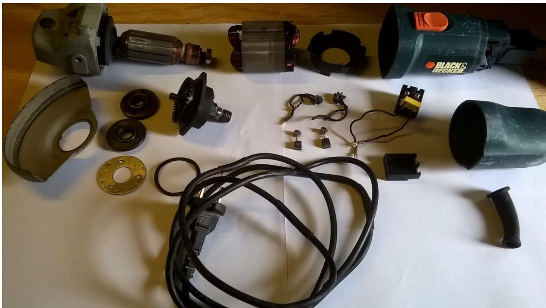
Εικόνα 14 Λύσιμο του γωνιακού τροχού
