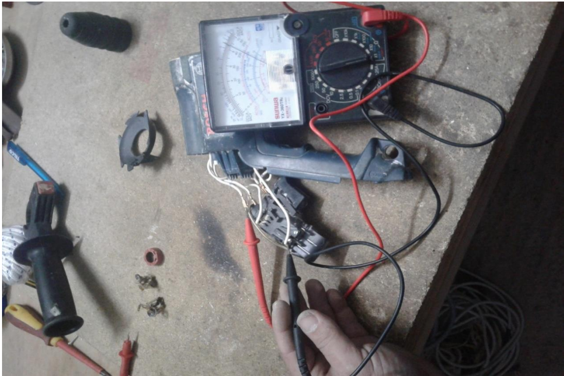
Εικόνα 33 Διαδικασία ελέγχου πηνίου
