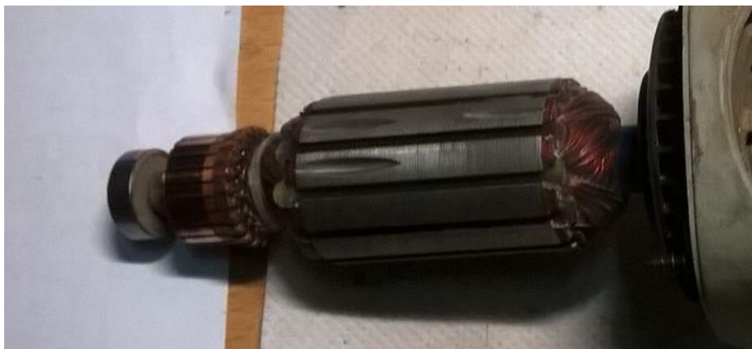
Εικόνα 20 Έλεγχος του συλλέκτη
