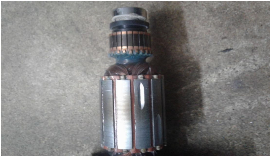
Εικόνα 32 Οπτικός έλεγχος του πηνίου του περιστροφικού άξονα
