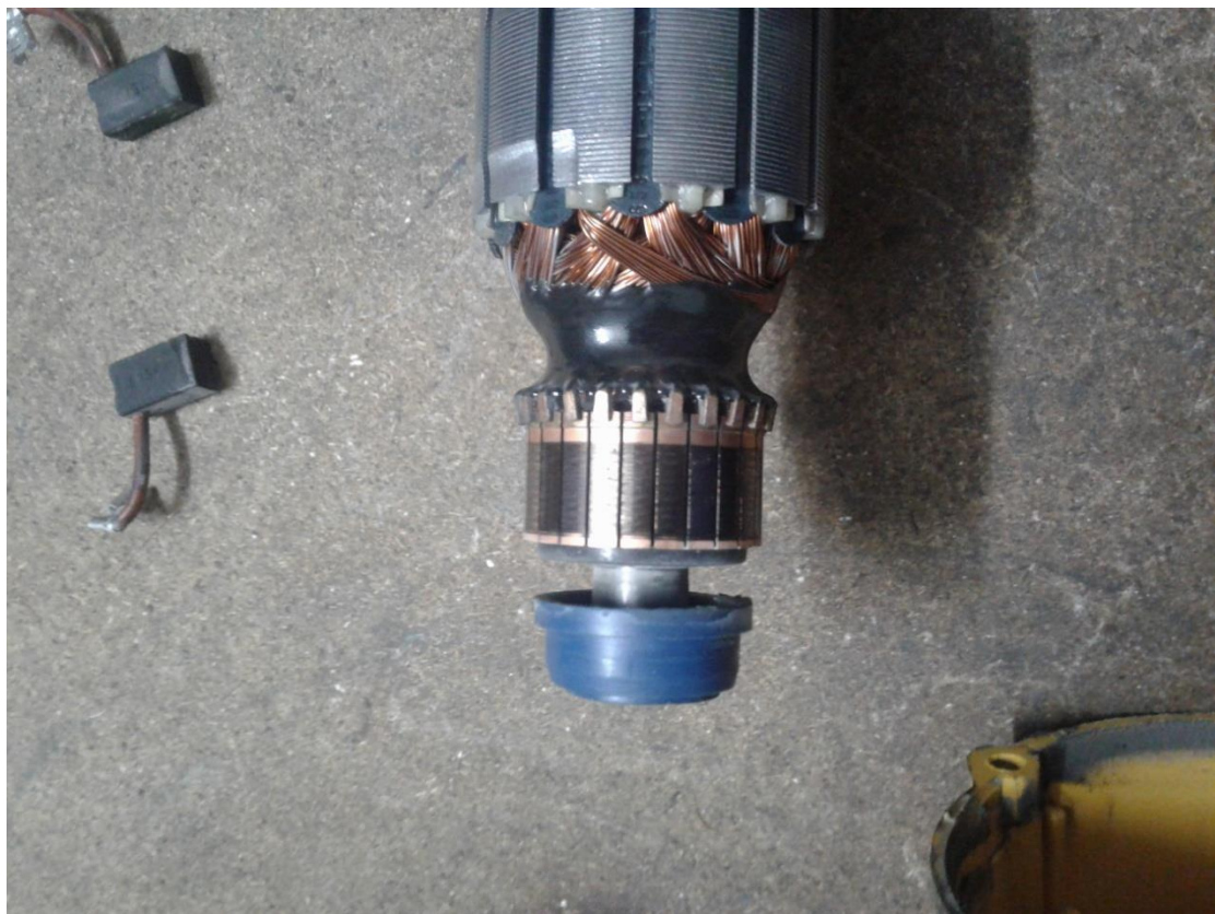
Εικόνα 43 Οπτικός έλεγχος συλλέκτη
