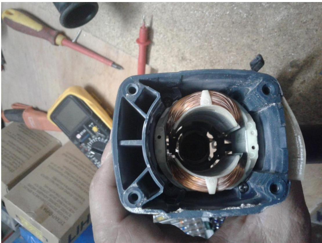
Εικόνα 34 Οπτικός έλεγχος πηνίου στάτη
