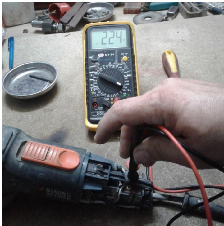
Εικόνα 16 Έλεγχος αγωγιμότητας και τάσης
