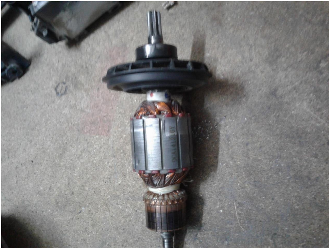
Εικόνα 54 Οπτικός έλεγχος πηνίου περιστροφικού άξονα
