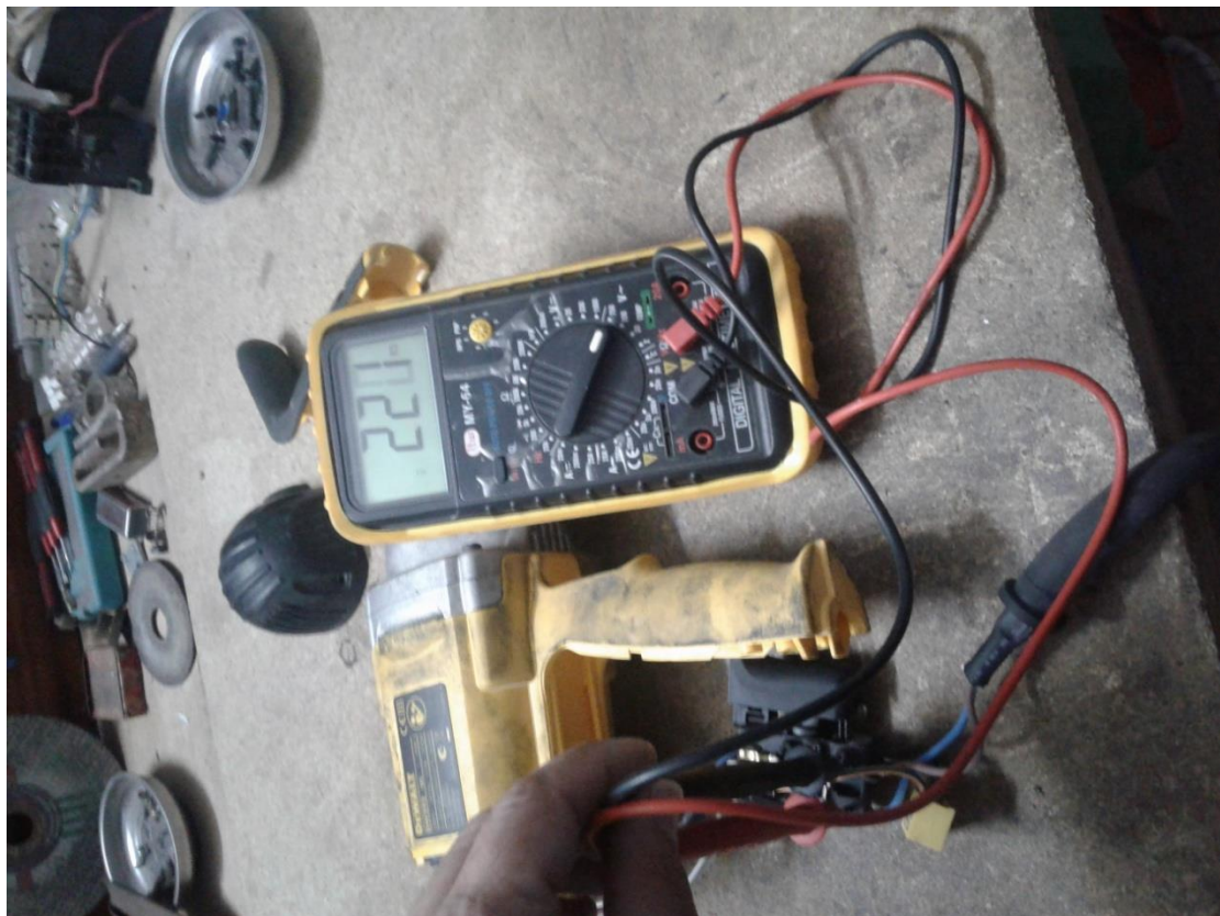
Εικόνα 39 Μέτρηση με χρήση βολτόμετρου
