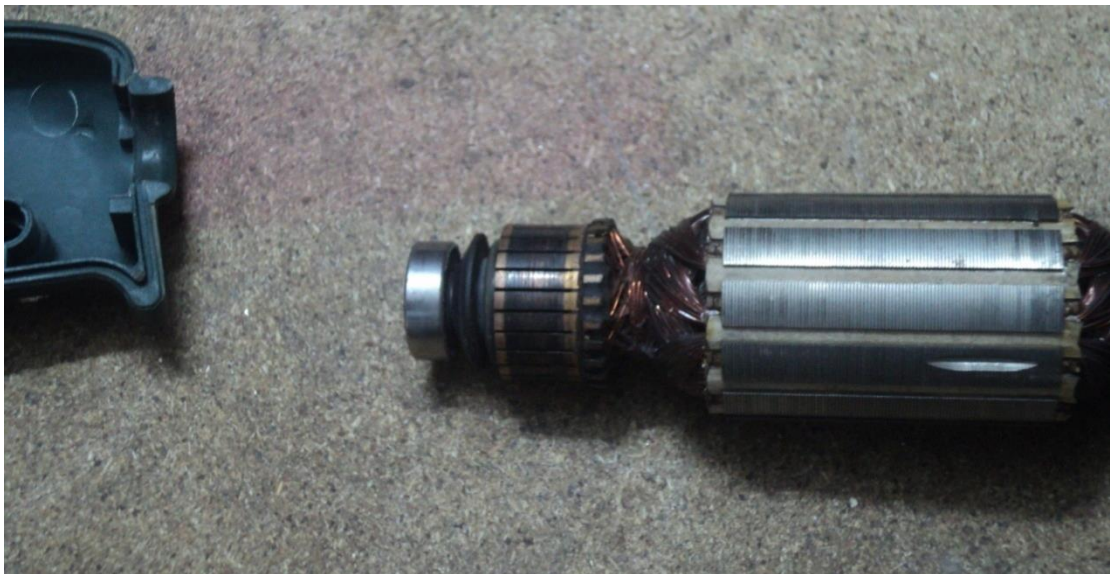
Εικόνα 80 έλεγχος του συλλέκτη περιλαμβάνει μόνο την οπτική επιθεώρηση
