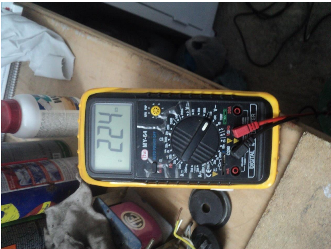
Εικόνα 5 Μετρητικός έλεγχος αγωγιμότητας και τάσης
