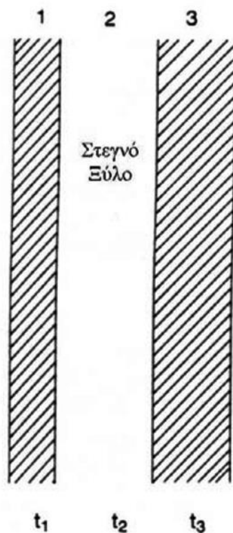
Σχήμα 4.6 Διπλή θωράκιση με ενδιάμεσο μονωτή
