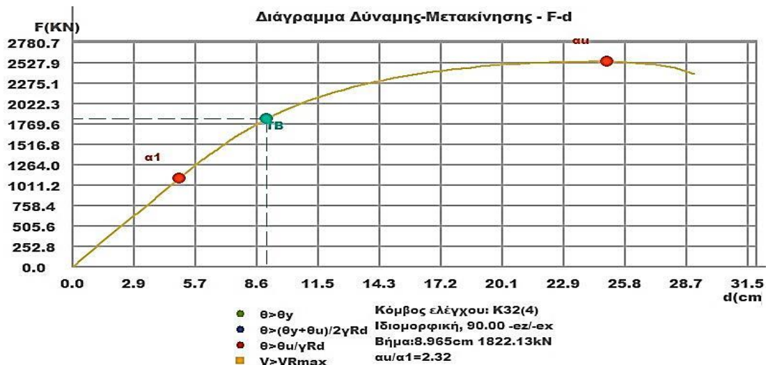
Σχήμα 4.42 Διάγραμμα F-d από ιδιομορφική κατανομή φόρτισης με κατεύθυνση (+90.00^\circ)
