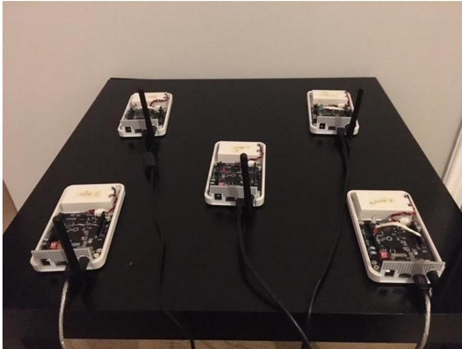
Εικόνα 4.15: Το δίκτυο 5 κόμβων όπως αυτό υλοποιήθηκε.
