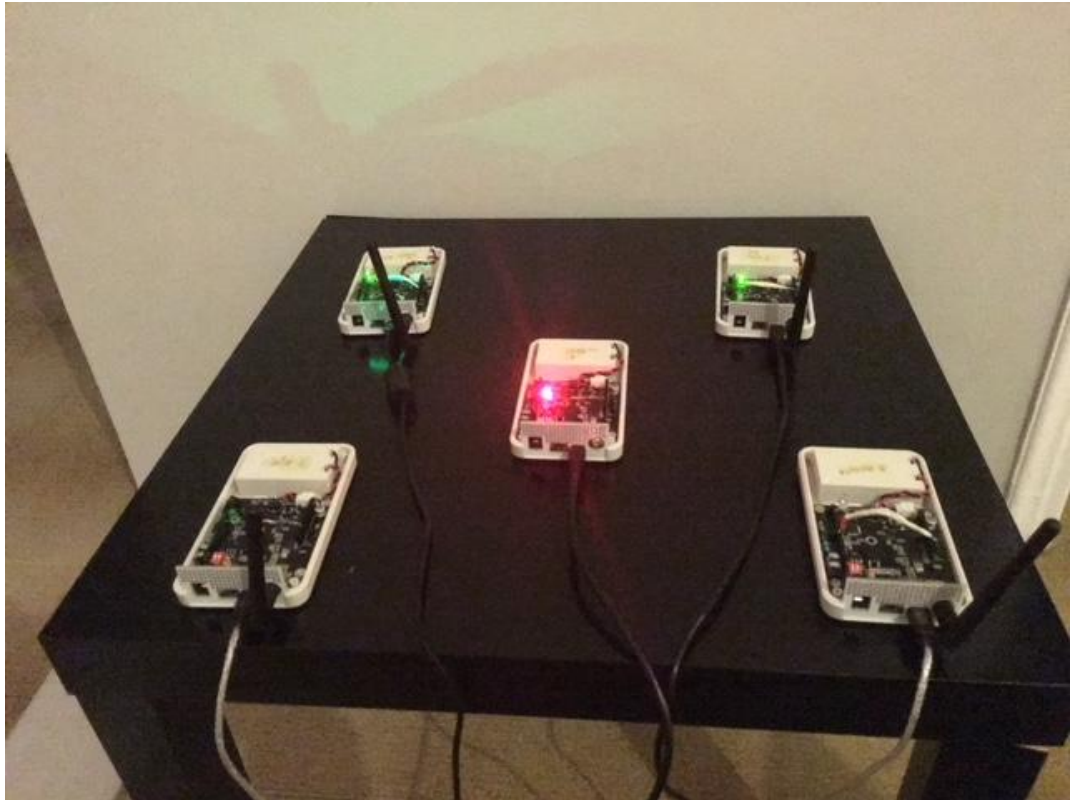
Εικόνα 4.23: Κόμβοι που εκπέμπουν από συγκεκριμένους λοβούς. Ενεργοί κόμβοι 1,4 και 5
