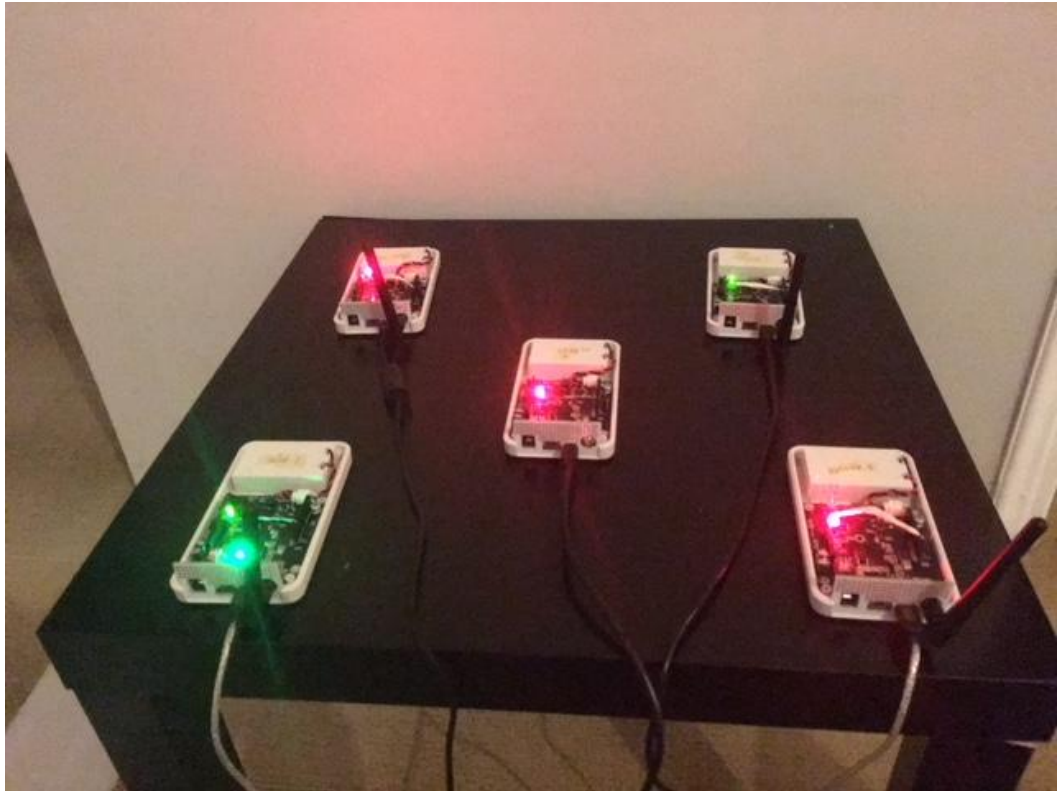
Εικόνα 4.25: Κόμβοι απαντες σε κατάσταση αποστολή μηνύματος. Να σημειωθεί πως σε σχέση με την εικόνα 4.24, ο κόμβος 1 χρησιμοποιεί διαφορετικό λοβό για να εκπέμψει.
